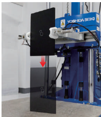
一定の荷重を繰り返し加えることにより、装置実装状態での各種部品への影響を確認します。
