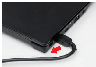
コネクタ部の耐久性を確認するため、Type-C ACアダプター、USBなどの各種インターフェースに対し、コネクタ挿抜の繰り返しや、大きな力で引っ張るといった試験を行い、強度のチェックを行います。
