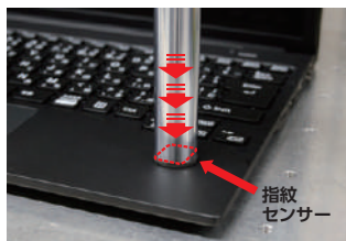
一定の荷重を繰り返し加えることにより、装置実装状態での各種部品への影響を確認します。
