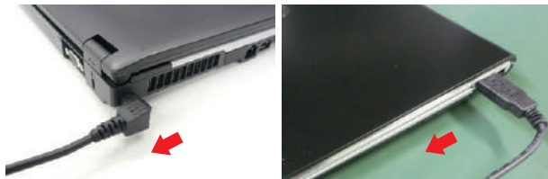
コネクタ部の耐久性を確認するため、ACアダプター、USBなどの各種インターフェースに対し、コネクタ挿抜の繰り返しや、大きな力で引っ張るといった試験を行い、強度のチェックを行います。
