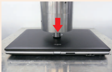
バックカバー(天板)の外側の一点に荷重を加え、強度チェックを行います。
