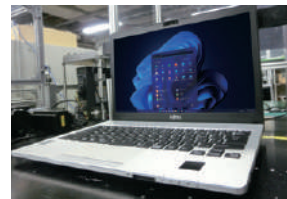
液晶ディスプレイの開閉動作を繰り返し、破損などが無い、耐久性のチェックを行います。
