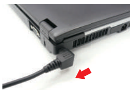
コネクタ部の耐久性を確認するため、ACアダプター、USB、PCカードなどの各種インターフェースに対し、コネクタ挿抜の繰り返しや、大きな力で引っ張るといった試験を行い、強度のチェックを行います。
