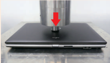
バックカバー（天板）の外側の一点に荷重を加え、強度チェックを行います。
