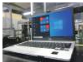
液晶ディスプレイの開閉動作を繰り返し、破損などがなければ、耐久性のチェックを行います。
