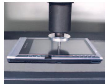
液晶パネルの外側の一点に荷重を加え、液晶パネルの強度チェックを行います。
