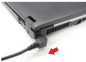
コネクタ部の耐久性を確認するため、ACアダプター、USB、PCカードなどの各種インターフェースに対し、コネクタ挿抜の繰り返しや、大きな力で引っ張るといった試験を行い、強度のチェックを行います。
