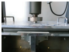
▼全面加圧試験
