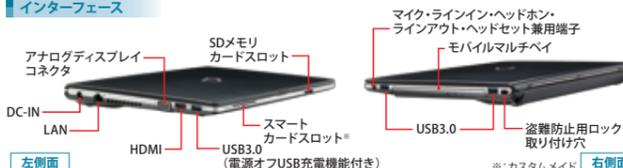
アナログディスプレイコネクタ | SDメモリカードスロット | マイク・ラインイン・ヘッドホン・ラインアウト・ヘッドセット兼用端子 | モバイルマルチベイ
