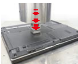
一定の荷重を繰り返し加えることにより、装置実装状態での各種部品への影響を確認します。
