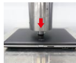
バックカバー(天板)の外側の一点に荷重を加え、強度チェックを行います。
