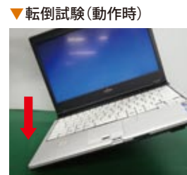
装置動作中に誤って転倒させた場合を想定し、HDD等への影響を確認します。
