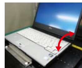
液晶ディスプレイの開閉動作を繰り返し、破損などがなく耐久性のチェックを行います。
