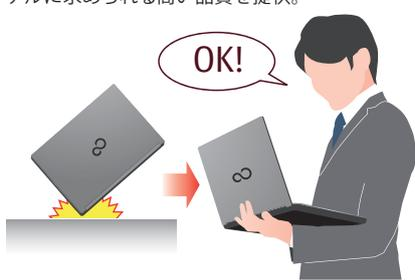
※落下、振動、液晶ディスプレイの開閉の繰り返しなど、さまざまな項目を独自の厳しい評価基準でチェックしています。
