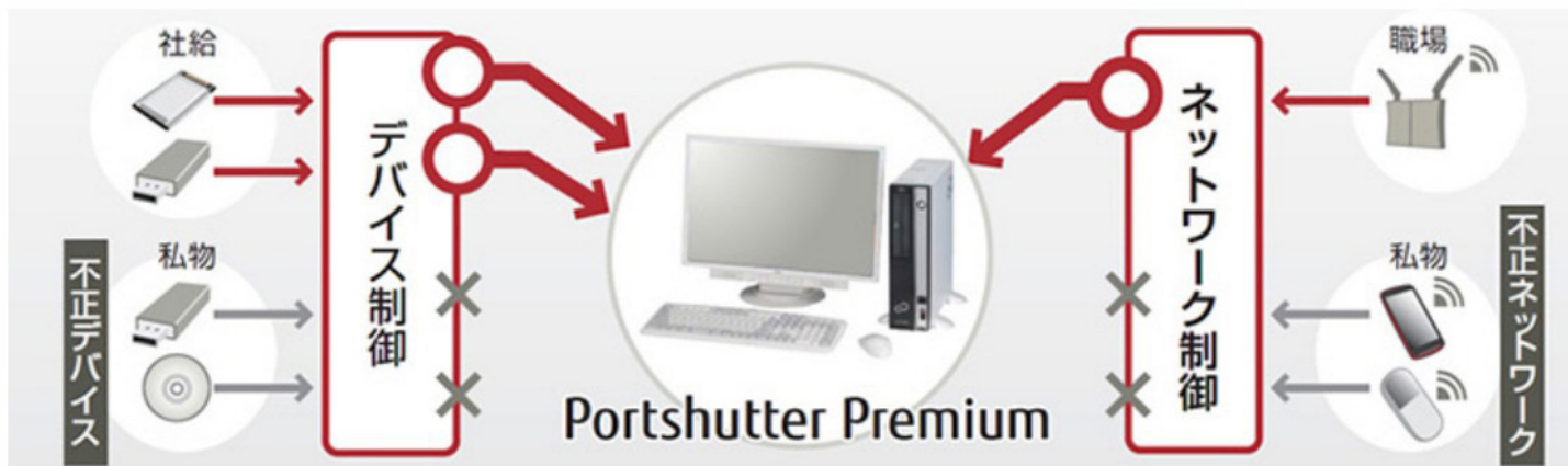
図3 Portshutter Premiumの仕組み
