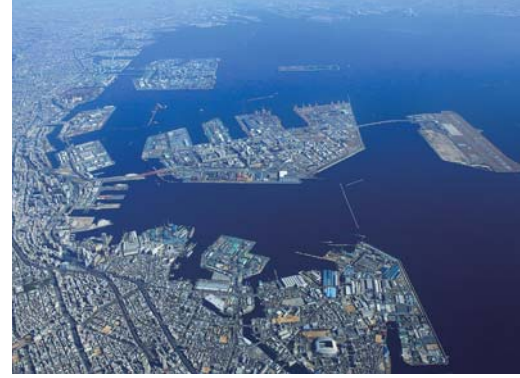
現在の神戸港。埠頭や巨大な人工島はすべて埋め立てで作られた
