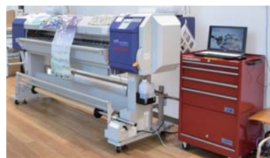
右) 染料インクをダイレクトプリントするデジタル捺染機は表現力豊か
