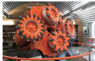
トンネルボーリングマシン836型。改良を加えて先進導坑と作業坑で活躍
