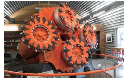
トンネルボーリングマシン836型。改良を加えて先進導坑と作業坑で活躍
