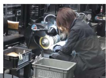
▲ 諏訪田製作所の研磨研削工程。研磨資材を変えて、本体を削り出し、滑らかに仕上げていく
