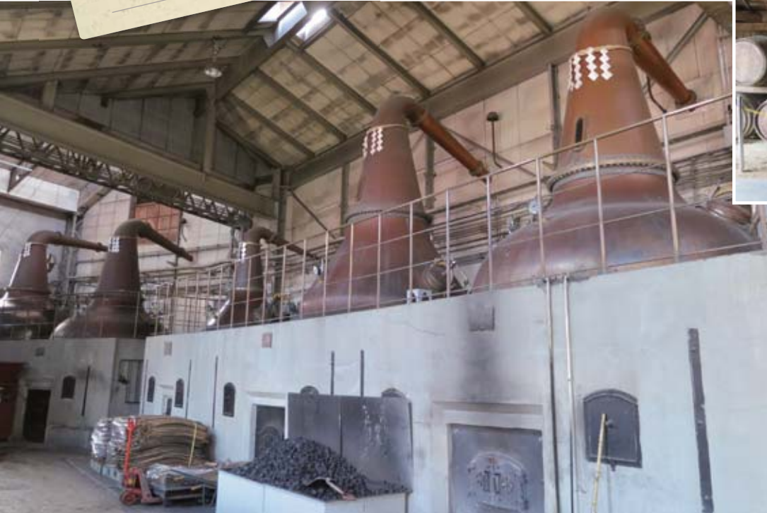
▲貯蔵庫と蒸溜棟内部。竹鶴氏の生家が造り酒屋だったため、もろみを蒸溜するポットスチルには注連縄が飾られている
