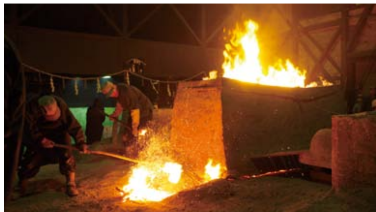
▲日刀保たたらは、年に3～5度操業している。造り上げられた玉鋼は、現代の刀匠たちの元へ送られる。写真/公益財団法人日本美術刀剣保存協会
