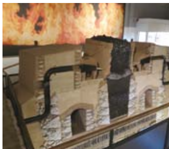
▲地下構造がわかるたたら断面モデル
