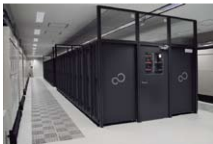
JSSの中核を担う「FX1」 ノード数3008個、120TFLOPS、総メモリ容量100TBytes、総ストレージ容量11PBytesの大規模システム
