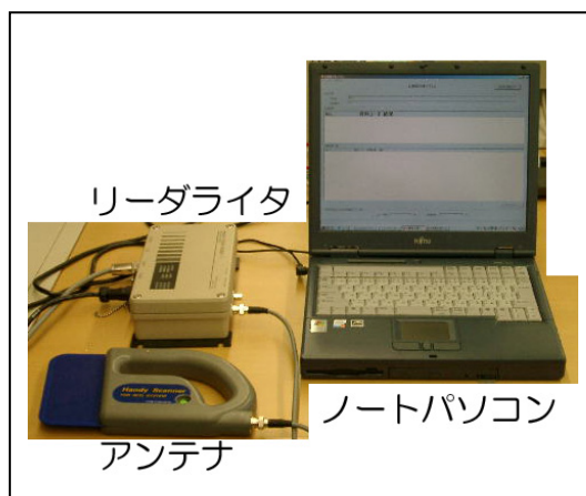
写真8 蔵書点検時の機器構成
