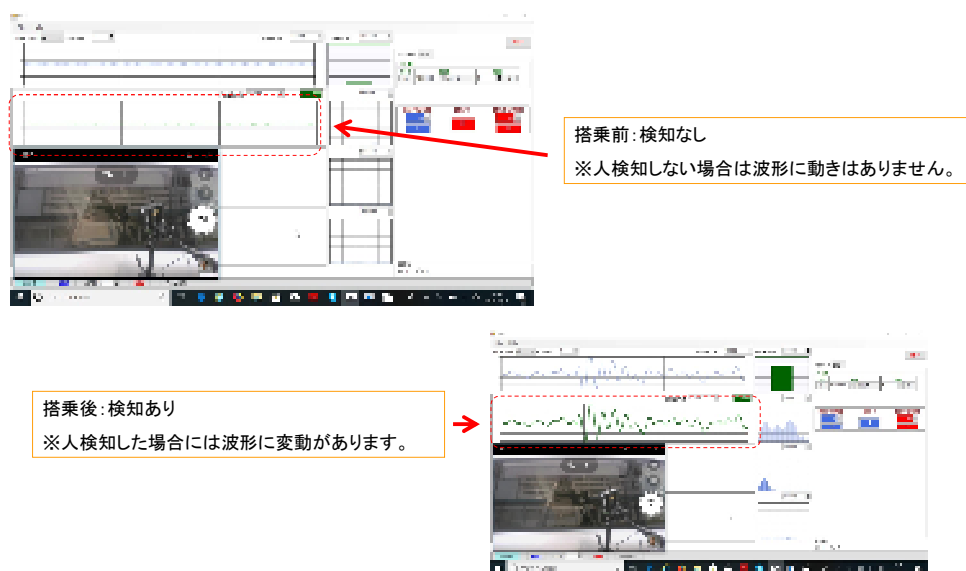
図 12 レーダーセンサーによる検知の実験イメージ
