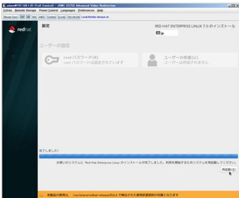
再起動ボタンをクリックし、再起動が始まるとから Fujitsu ロゴが表示されている間までに DVD ドライブの Eject ボタンを押してディスクを抜き取ってください。
