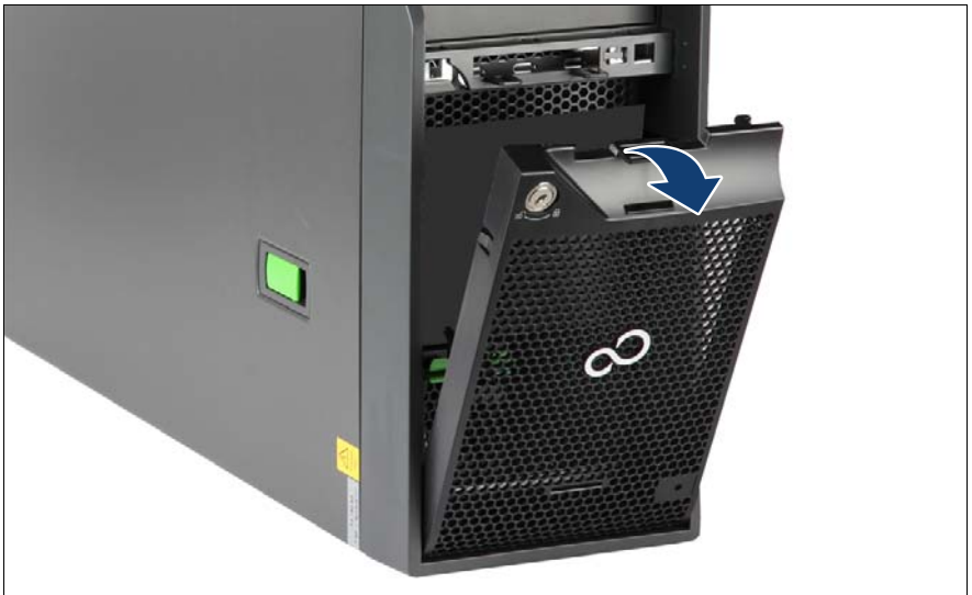
図 11: HDD ベイカバーの取り外し
