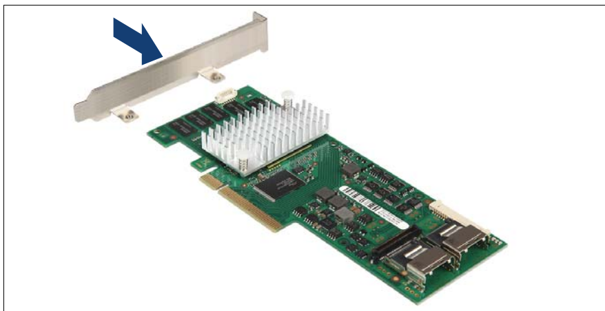
図 76: PCI スロットブラケットの取り付け (A)
