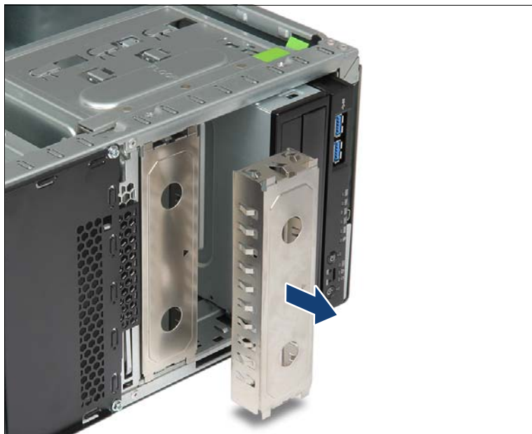
図 139: アクセス可能なドライブのフィラーカバーの取り外し
