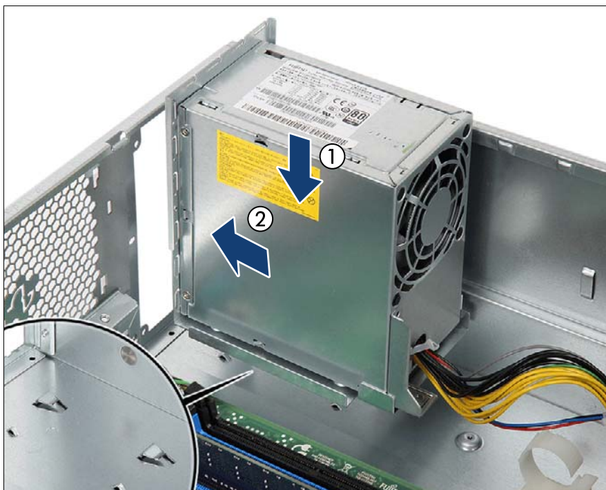
図 33: 標準電源ユニットの取り付け
