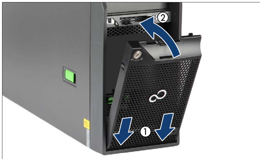
図 20: HDD ベイカバーの取り付け
