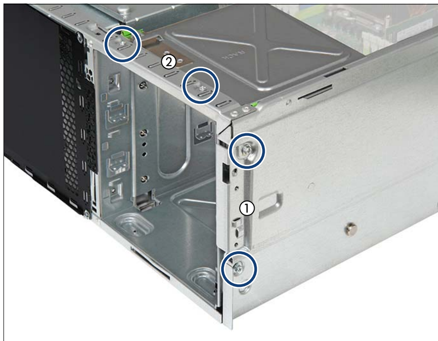
図 196: アクセス可能なドライブケースを固定する (A)
