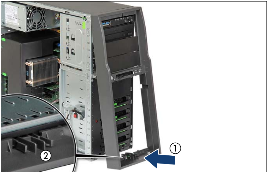
図 19: フロントカバーの取り付け（タワーサーバ）（B）
