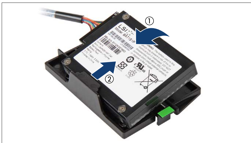
図 121: BBU ホルダーからの BBU の取り外し
