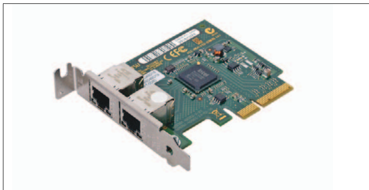
図 83: 組み立てられているネットワークアダプタ D3035
