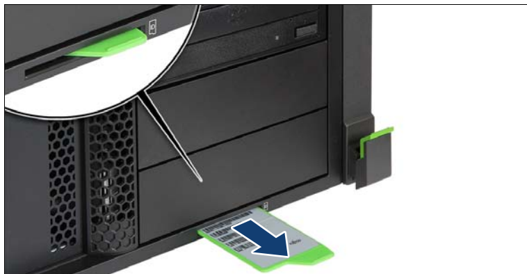
図 6: ID カードの取り外し（ラックサーバ）
