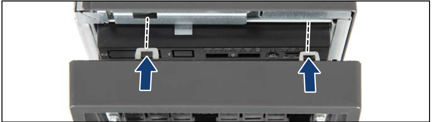
図 18: フロントカバーの取り付け（タワーサーバ）（A）
