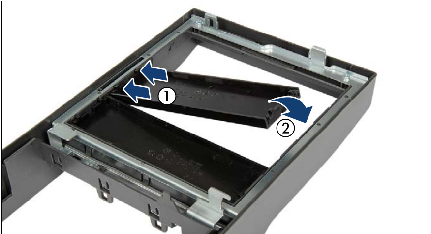
図 152: アクセス可能なドライブカバーの取り付け
