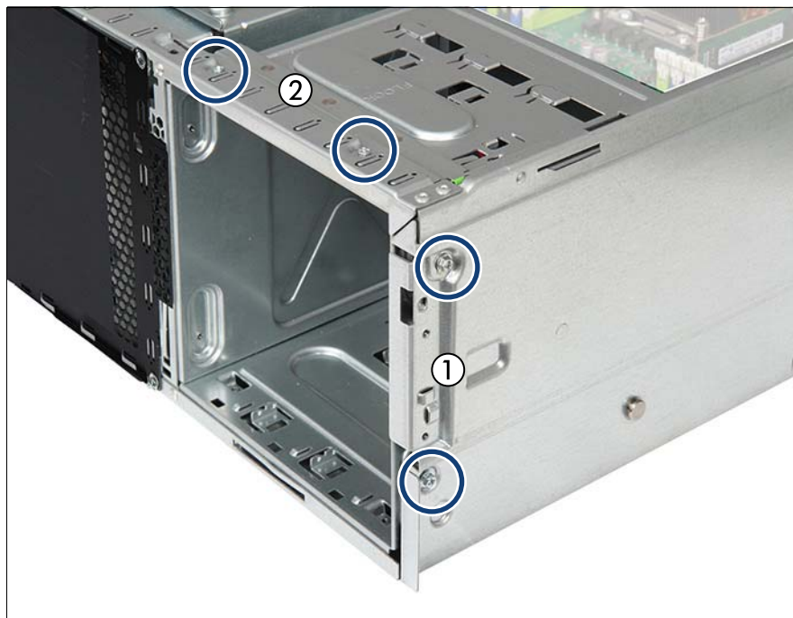
図 192: アクセス可能なドライブベイを取り外す (B)
