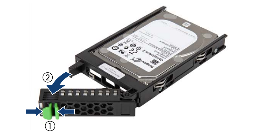
図 45: 2.5 インチ HDD/SSD モジュールのロックレバーを開く
