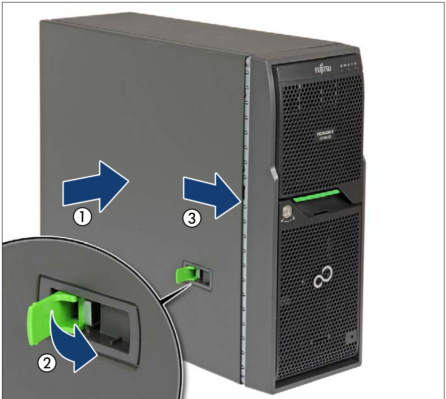
図 21: サイドカバーの取り付け（タワーサーバ）
