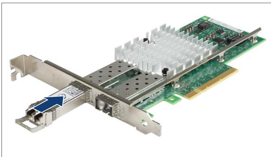
図 91: SFP+ トランシーバモジュールの挿入
