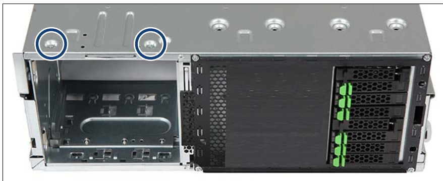
図 191: アクセス可能なドライブケースを取り外す (A)
