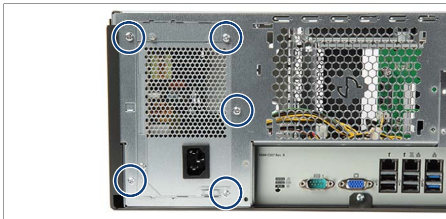
図 27: 標準電源ユニットの取り外し
