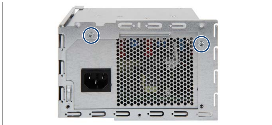
図 32: 取り付けフレームの電源ユニットへの固定
