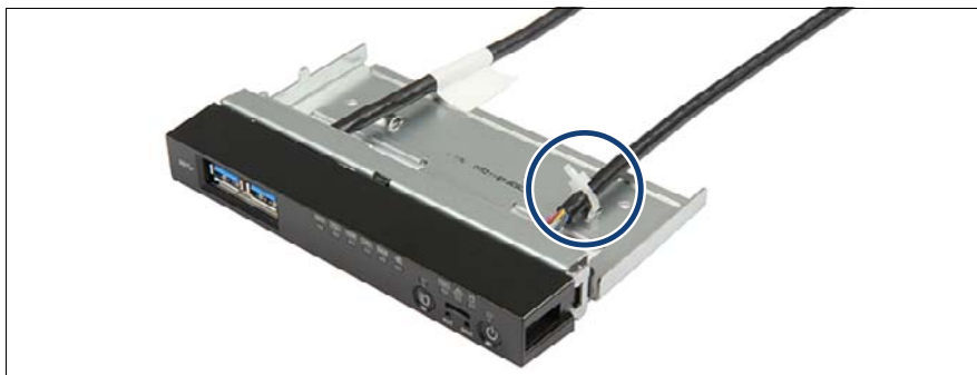
図 155: ケーブルクランプの取り外し
