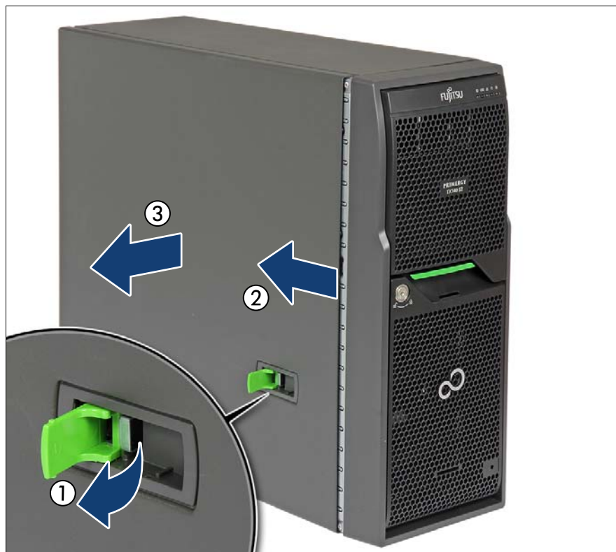
図 10: サイドカバーの取り外し (タワーサーバ)
