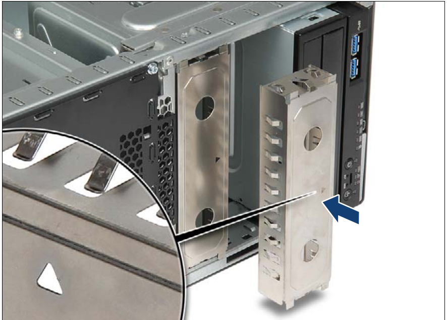
図 151: アクセス可能なドライブフィラーカバーの取り付け
