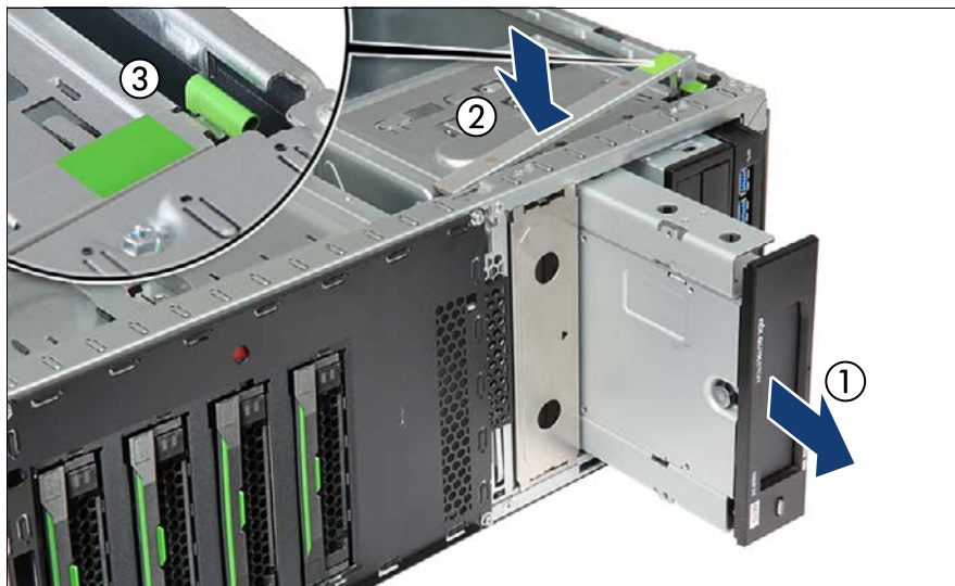
図 150: アクセス可能なドライブの取り外し
