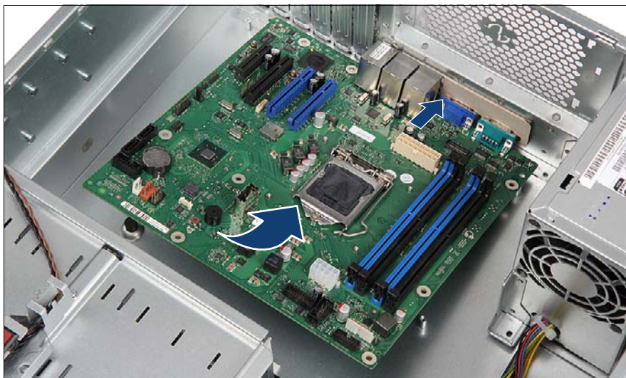
図 180: システムボードの取り付け（A）
