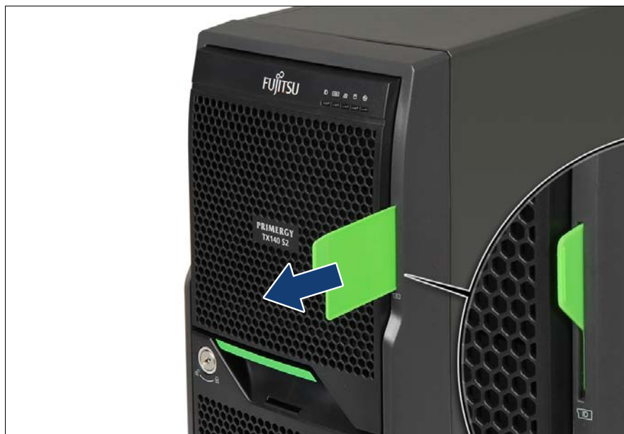
図 12: ID カードの取り外し（タワーサーバ）
