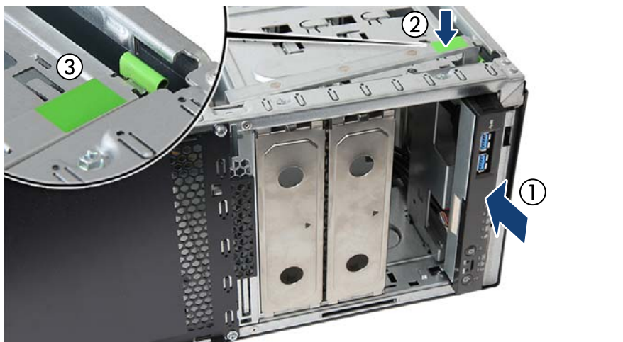
図 157: フロントパネルモジュールの取り付け
