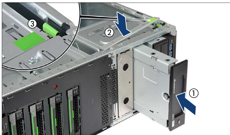
図 149: アクセス可能なドライブの取り付け
