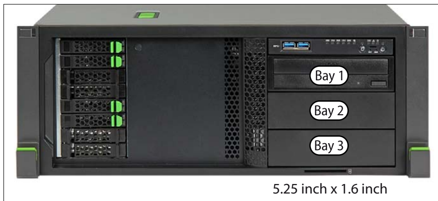
図 138: アクセス可能なドライブの取り付け順序（ラックサーバ）
