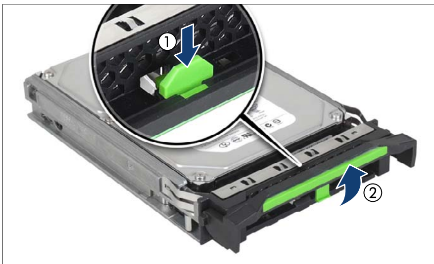
図 54: 3.5 インチ HDD モジュールのロックレバーを開く
