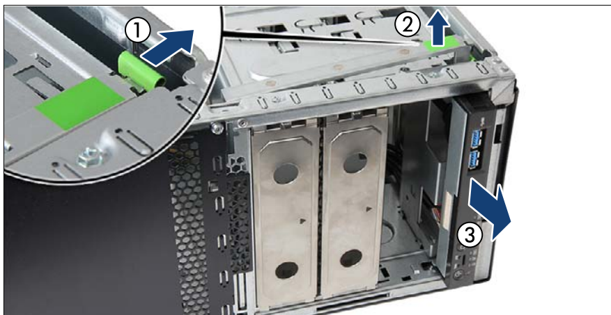
図 154: フロントパネルモジュールの取り外し
