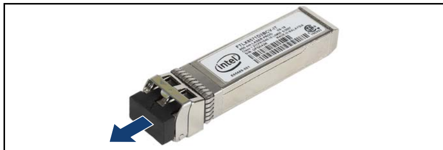
図 89: 光ポート保護プラグの取り外し
