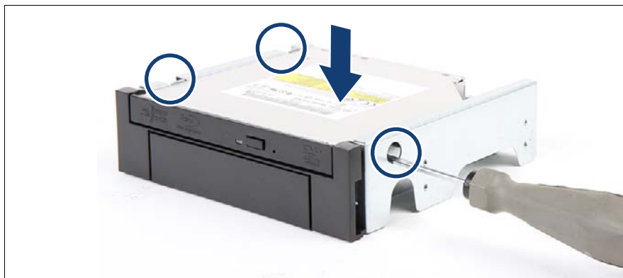
図 146: 薄型 ODD のスライドインユニットへの取り付け
