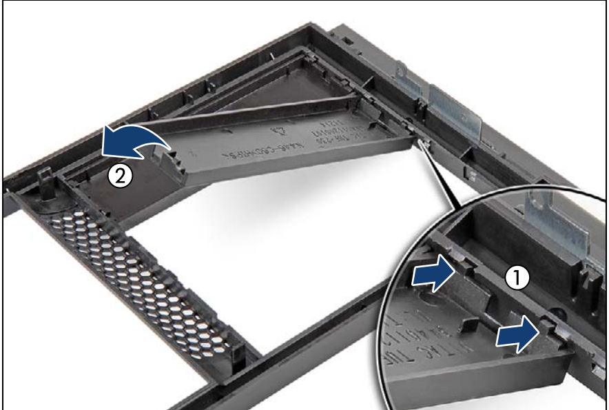
図 200: アクセス可能なドライブのダミーカバーの取り付け
