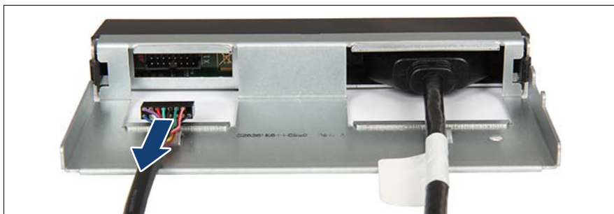
図 156: フロントパネルケーブルの取り外し
