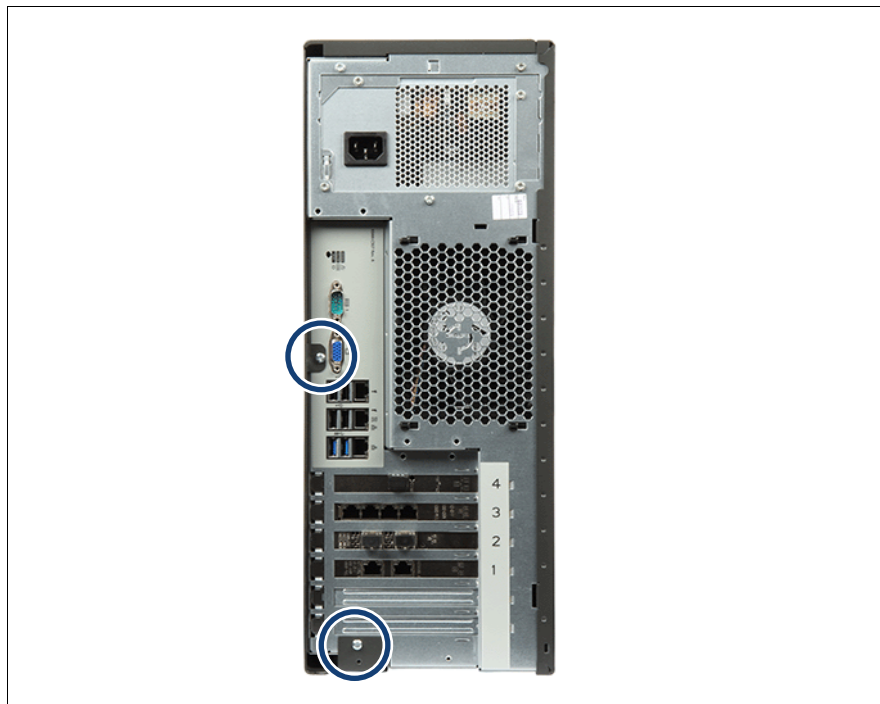
図 188: 右側のサイドカバーの取り外し (A)
