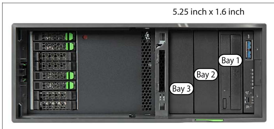
図 137: アクセス可能なドライブの取り付け順序（タワーサーバ）
