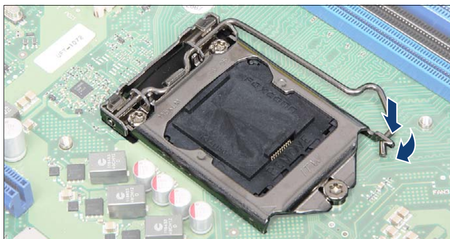
図 187: ソケット保護カバーの取り付け（故障しているシステムボード）（C）
