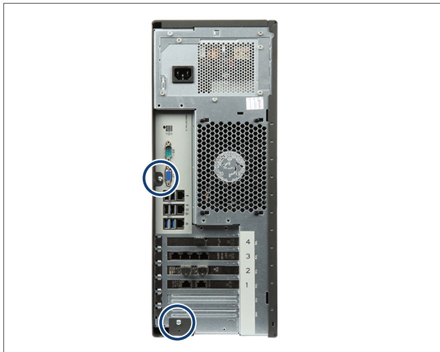
図 189: 右側のサイドカバーの取り外し (A)
