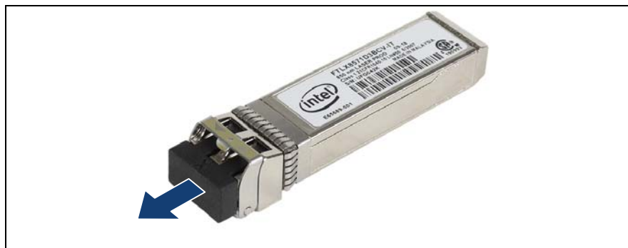
図 88: 光ポート保護プラグの取り外し
