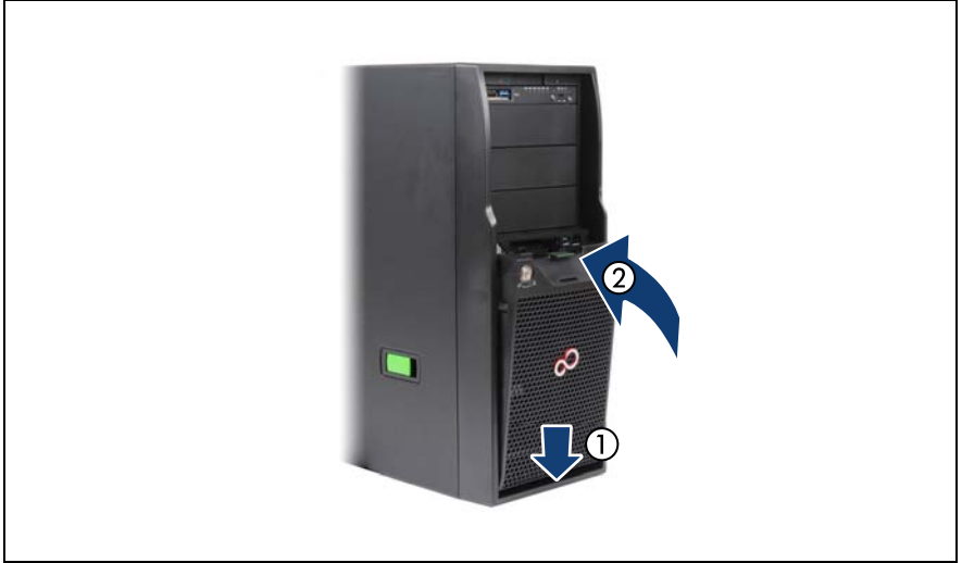
図 20: HDD ベイカバーの取り付け
