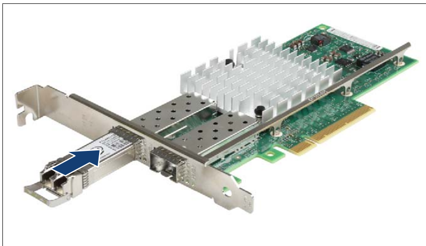
図 90: SFP+ トランシーバモジュールの挿入
