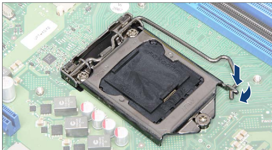
図 188: ソケット保護カバーの取り付け（故障しているシステムボード）(C)
