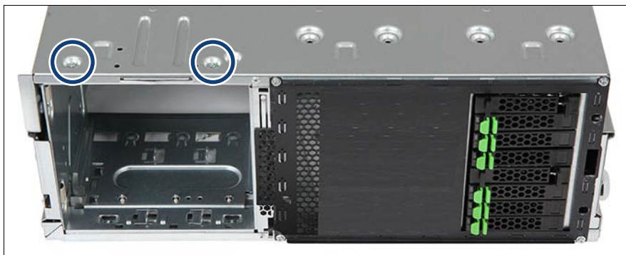
図 192: アクセス可能なドライブケースを取り外す (A)
