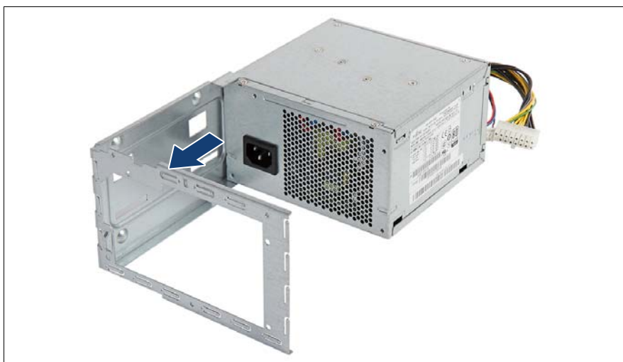
図 30: 取り付けフレームの電源ユニットからの取り外し (B)
