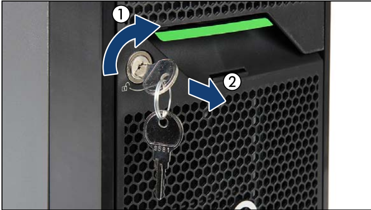
図 9: サーバロックの解除
