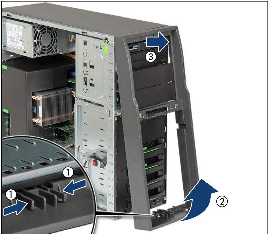
図 13: フロントカバーの取り外し (タワーサーバ)
