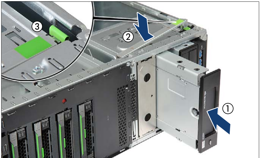
図 148: アクセス可能なドライブの取り付け
