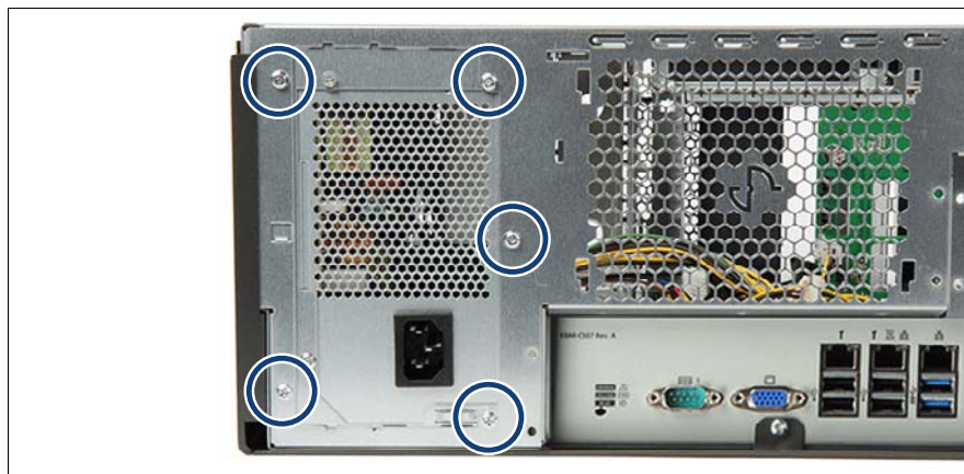
図 27: 標準電源ユニットの取り外し
