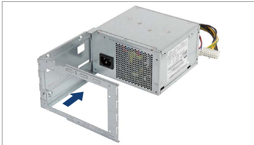
図 31: 取り付けフレームの電源ユニットへの取り付け
