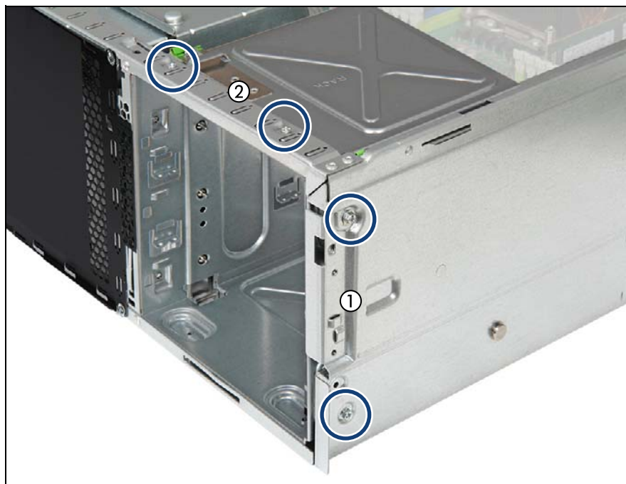
図 197: アクセス可能なドライブケースを固定する (A)
