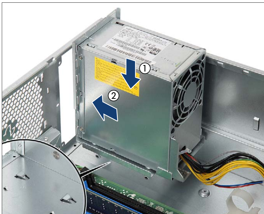
図 33: 標準電源ユニットの取り付け
