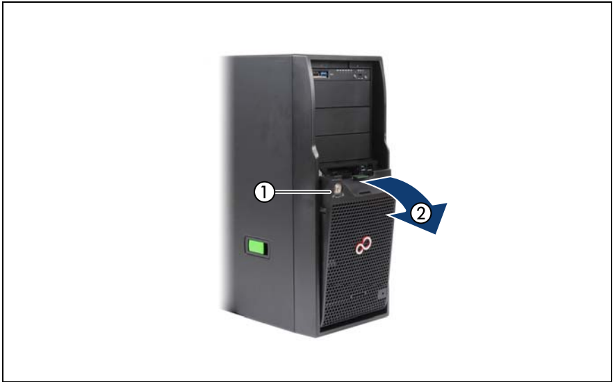
図 11: HDD カバーの取り外し
