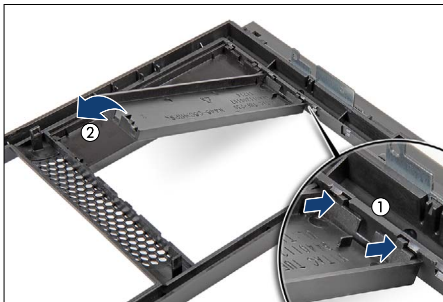
図 201: アクセス可能なドライブのダミーカバーの取り付け
