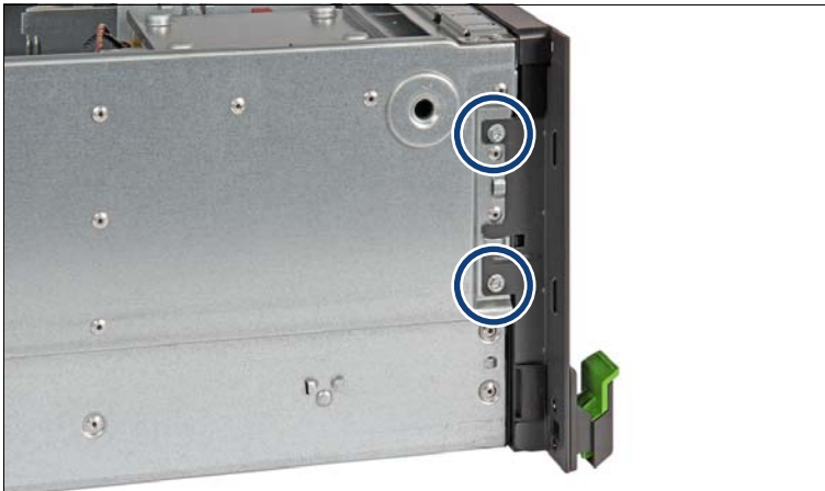
図 7: ラックフロントカバーの取り外し（A）
