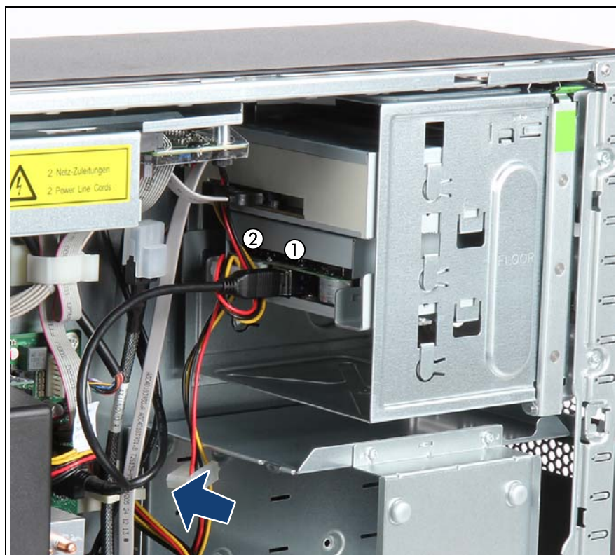
図 149: RDX バックアップドライブのケーブル配線
