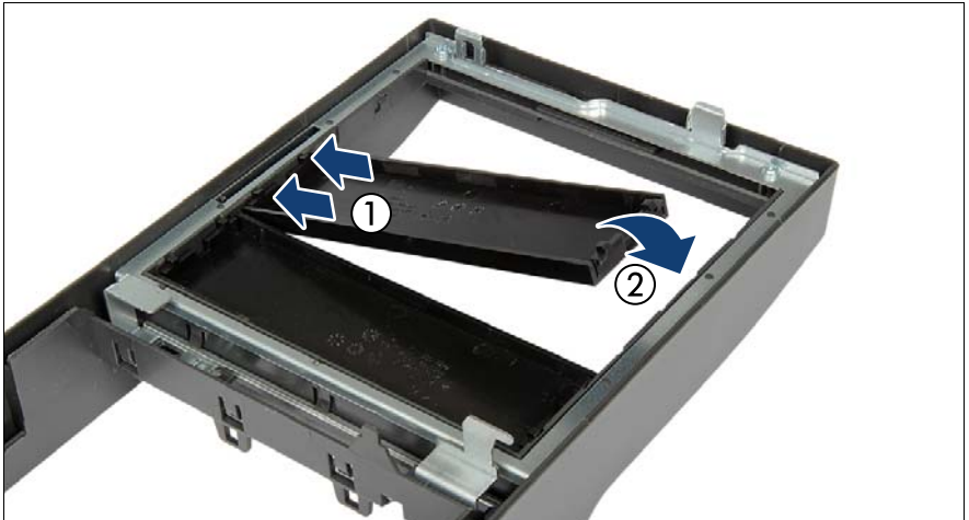
図 153: アクセス可能なドライブカバーの取り付け
