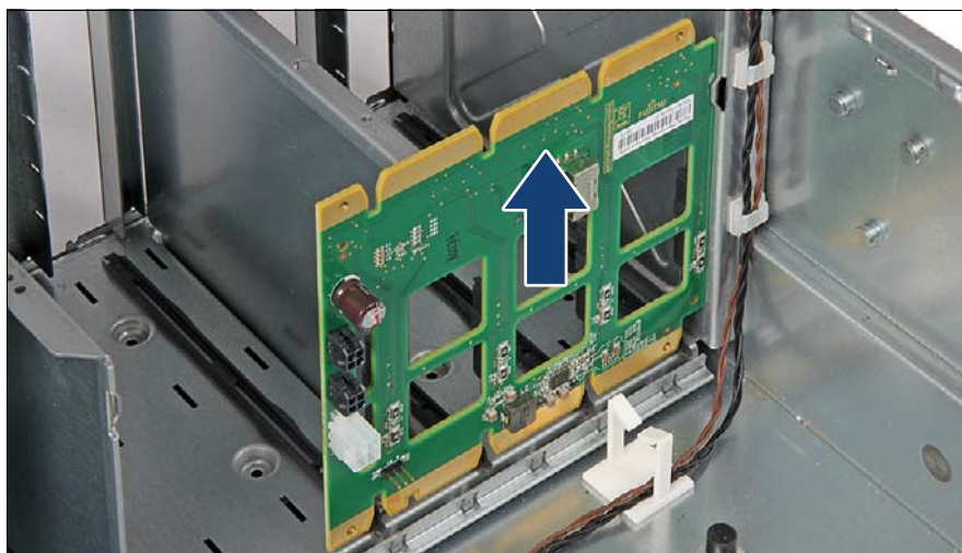
図 62: 3.5 インチ HDD SAS バックプレーンの取り外し
