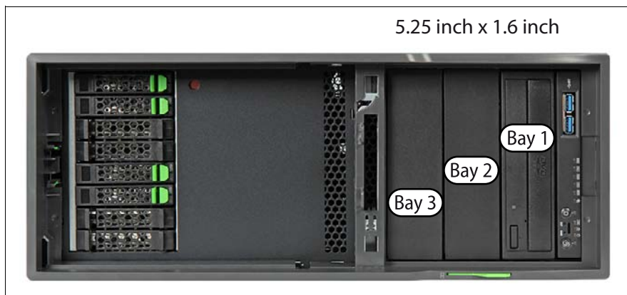
図 136: アクセス可能なドライブの取り付け順序（タワーサーバ）
