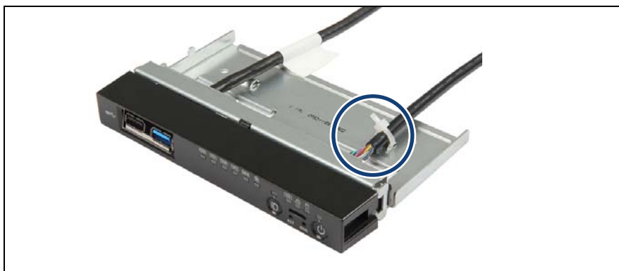
図 156: ケーブルクランプの取り外し
