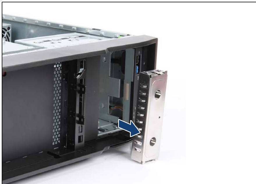
図 138: アクセス可能なドライブのフィラーカバーの取り外し
