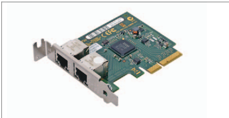
図 84: 組み立てられているネットワークアダプタ D3035
