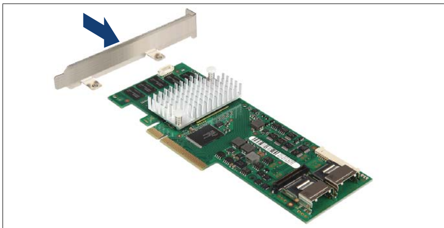
図 77: PCI スロットブラケットの取り付け (A)
