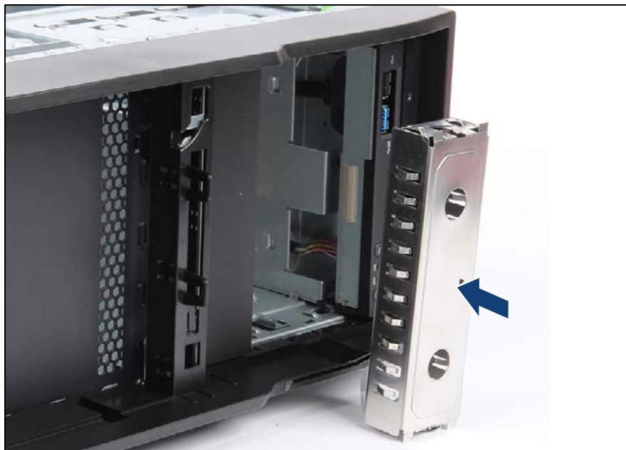
図 152: アクセス可能なドライブフィラーカバーの取り付け
