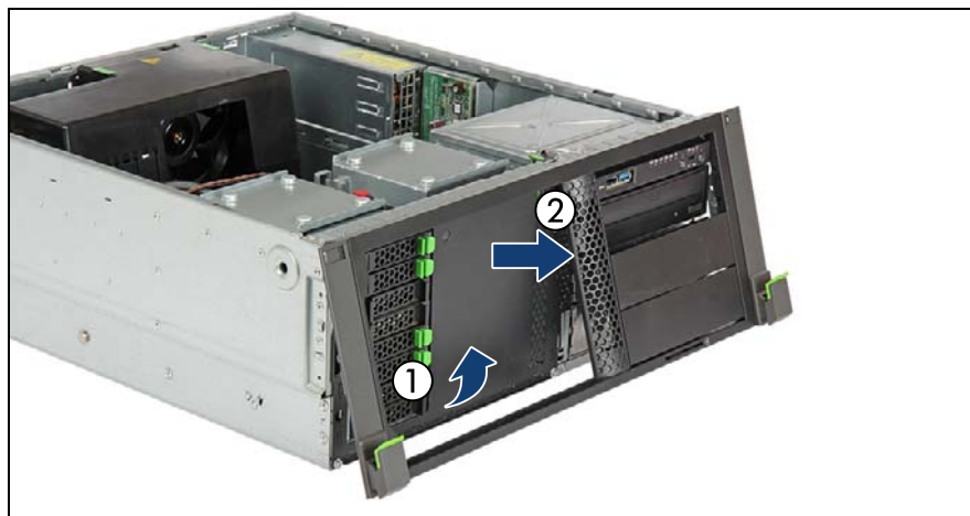
図 8: ラックフロントカバーの取り外し (B)
