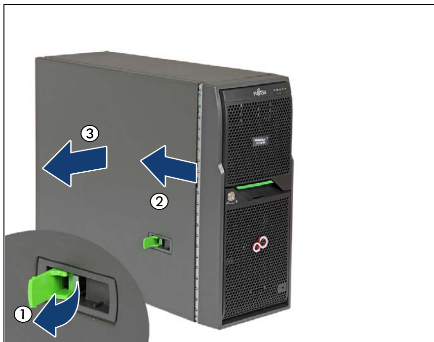
図 10: サイドカバーの取り外し（タワーサーバ）
