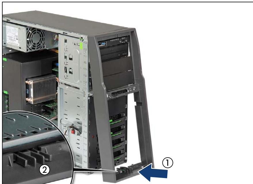
図 19: フロントカバーの取り付け（タワーサーバ）（B）
