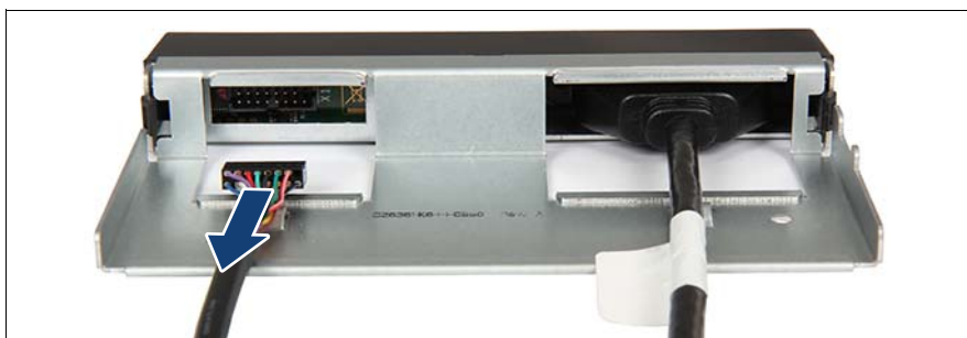
図 157: フロントパネルケーブルの取り外し
