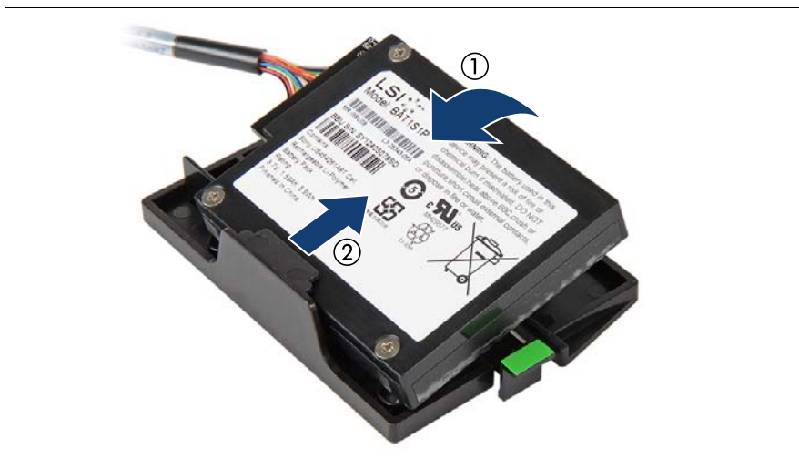
図 120: BBU ホルダーからの BBU の取り外し
