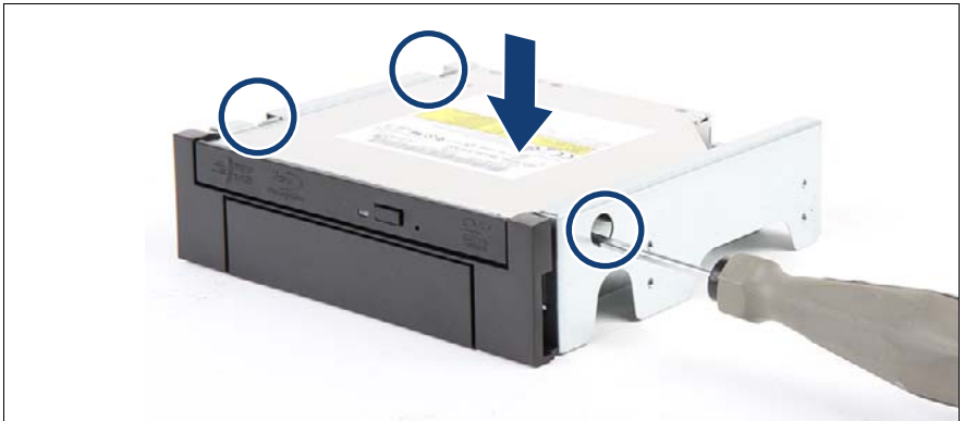
図 145: 薄型 ODD のスライドインユニットへの取り付け
