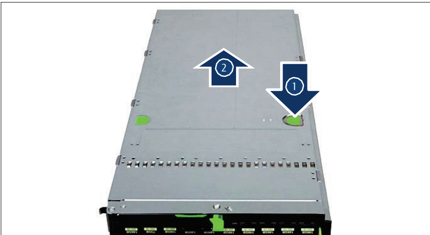
図 17: ストレージブレードを開く
