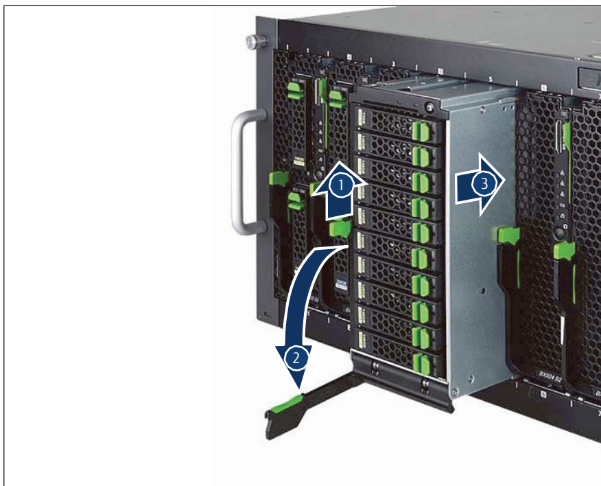
図 6: ストレージブレードのロック解除と取り付け
