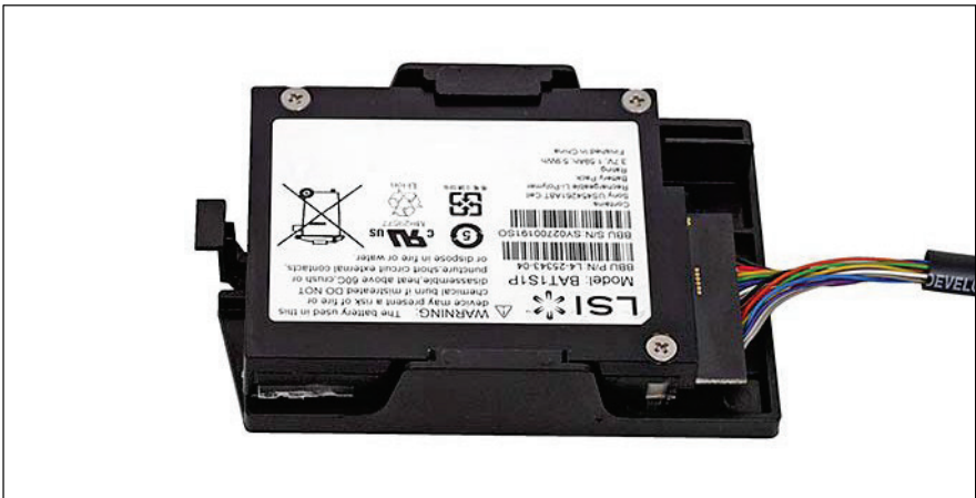
図 38: BBU08 ホルダーに BBU08 の取り付け (B)
