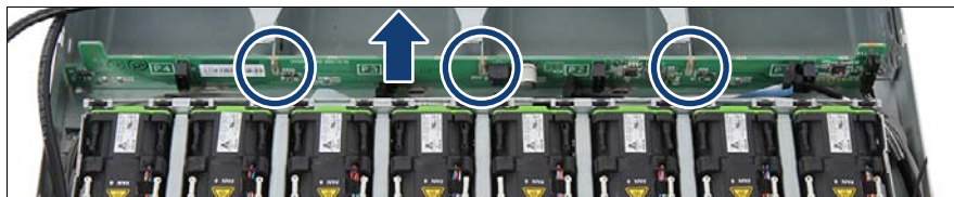
図 78: 3.5 インチ HDD バックプレーンの取り外し
