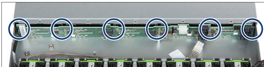
図 63: 10 x 2.5 インチ HDD バックプレーンの取り外し
