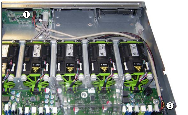
図 51: OOB ケーブルの取り外し - HDD バックプレーン x1
