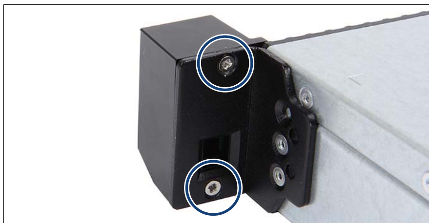
図 205: QRL のフロントパネルの取り外し（A）
