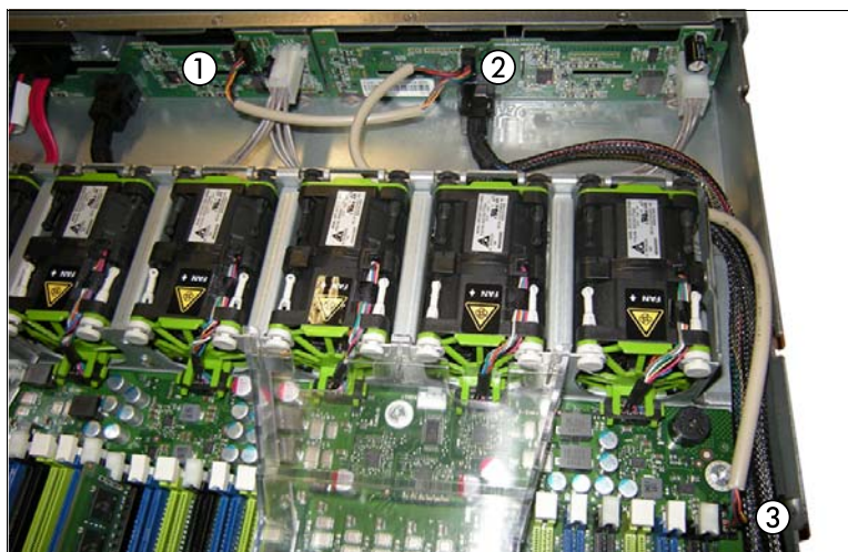
図 52: OOB ケーブルの取り外し - HDD バックプレーン x2
