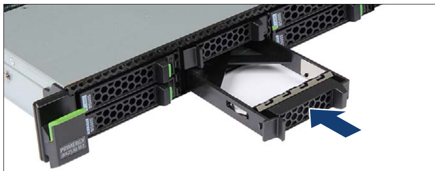
図 49: 2.5 インチ ダミーモジュールの取り付け
