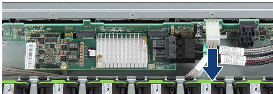
図 59: HDD バックプレーンから電源ケーブルの取り外し
