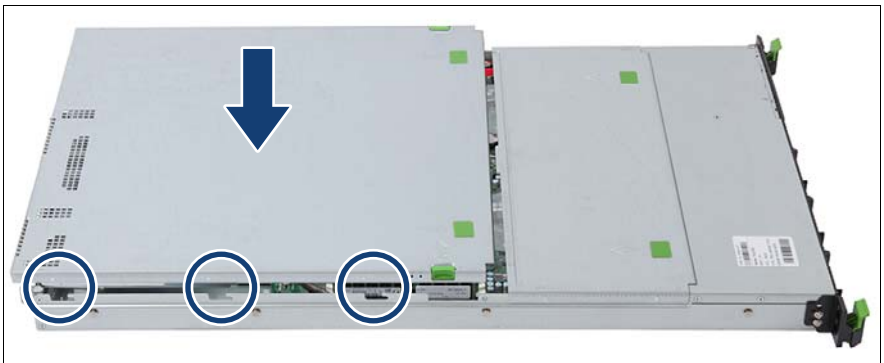
図 9: 上面カバーの取り付け (A)
