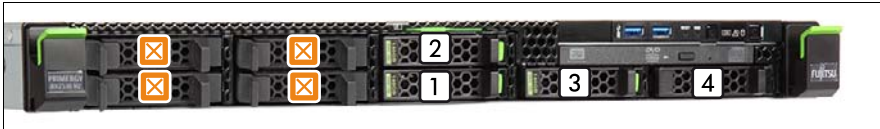
図 38: 最大 4 台の 2.5 インチ HDD/SSD の命名体系
