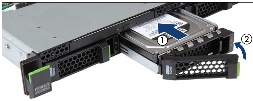
図 74: 3.5 インチ HDD モジュールの取り付け
