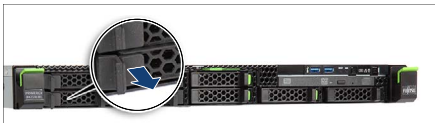
図 45: ダミーロックの取り外し
