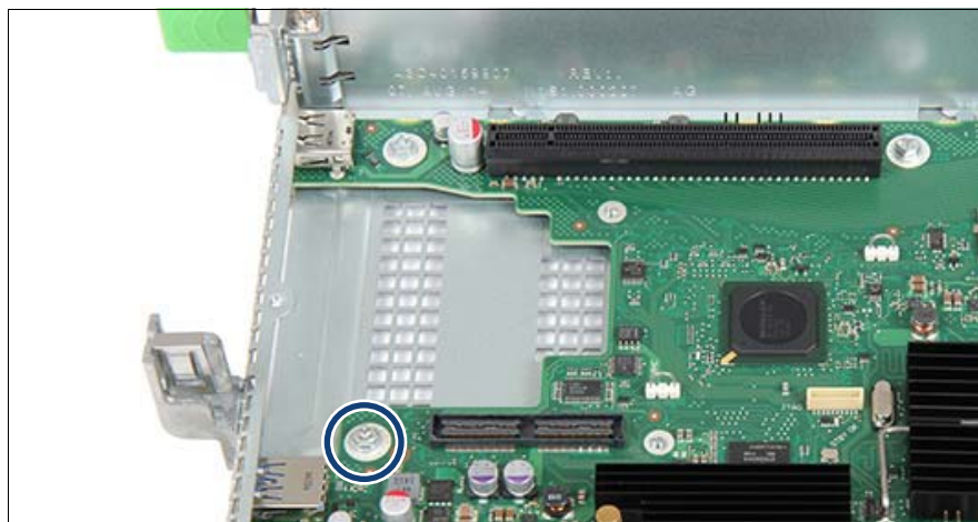
図 112: システムボードネジの取り外し
