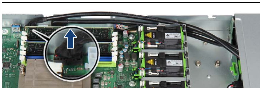
図 193: ケーブルの取り外し (B)
