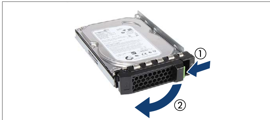
図 73: 3.5 インチ HDD モジュールのロックレバーを開く
