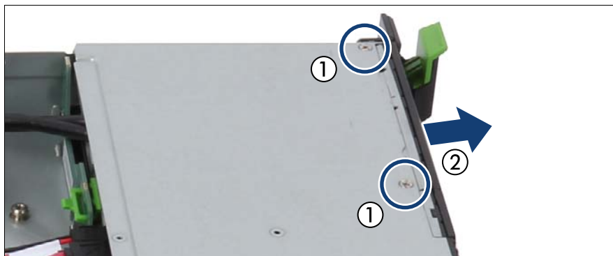
図 194: フロントパネルモジュールの取り外し
