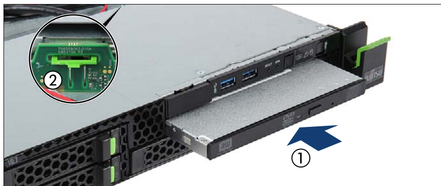
図 186: ODD の取り付け
