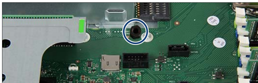
図 221: システムボードに残った UFM スペーサー
