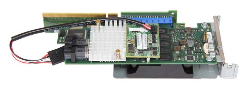
図 151: FBU ケーブルの配線
