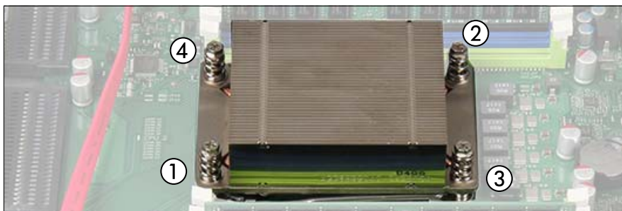
図 178: ヒートシンクの取り付け
