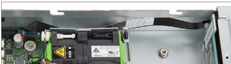
図 210: フロントパネルケーブルの配線
