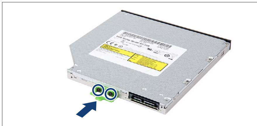
図 185: ODD への ODD ラッチの取り付け
