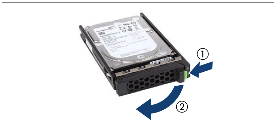
図 47: 2.5 インチ HDD/SSD モジュールのロックレバーを開く
