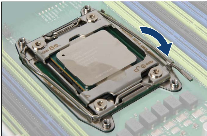
図 168: ソケットリリースレバー 1 を閉じます。
