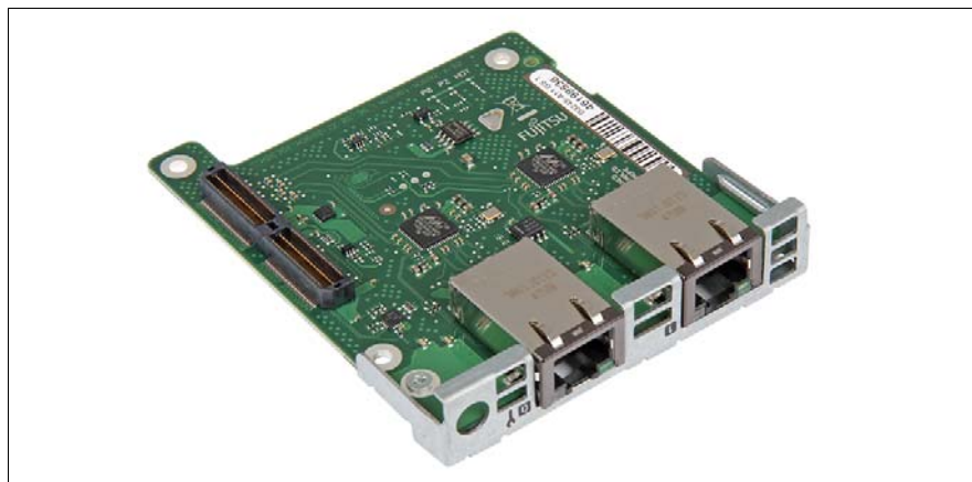
図 90: DynamicLoM モジュール D3245
