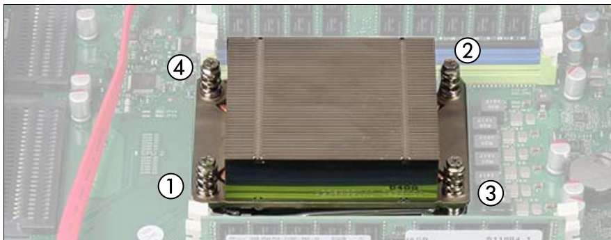
図 172: ヒートシンクの取り外し
