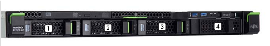
図 71: 最大 4 台の 3.5 インチ HDD の命名体系
