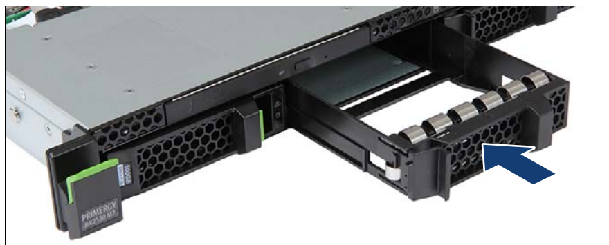
図 75: 3.5 インチダミーモジュールの取り付け
