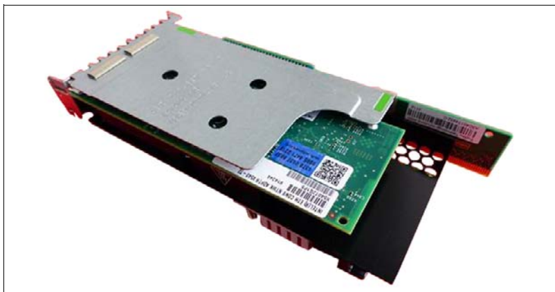
図 120: 2 つのコントローラが取り付けられたライザーモジュール 1
