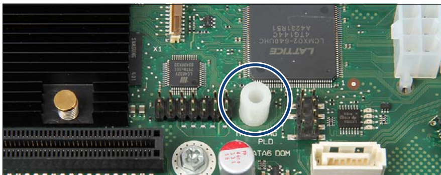
図 228: システムボードへの TPM スペーサーの挿入
