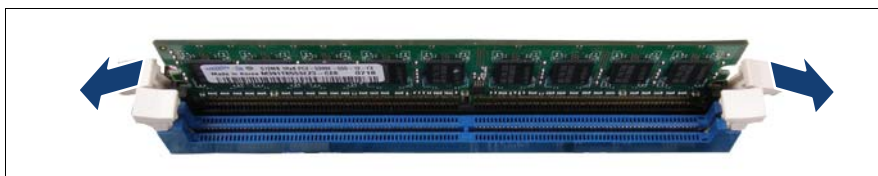
図 159: メモリモジュールの取り外し (A)
