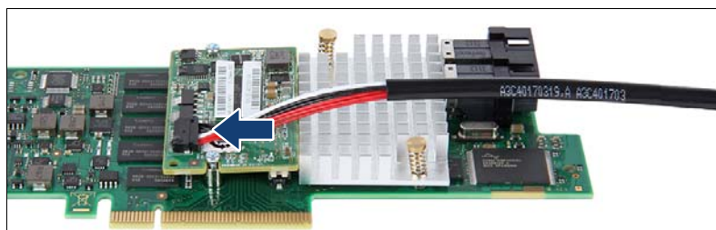
図 133: FBU アダプタケーブルの接続
