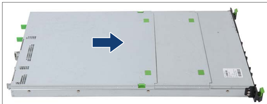
図 10: 上面カバーの取り付け (B)
