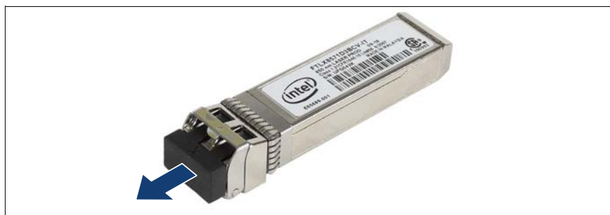
図 102: 光ポート保護プラグの取り外し
