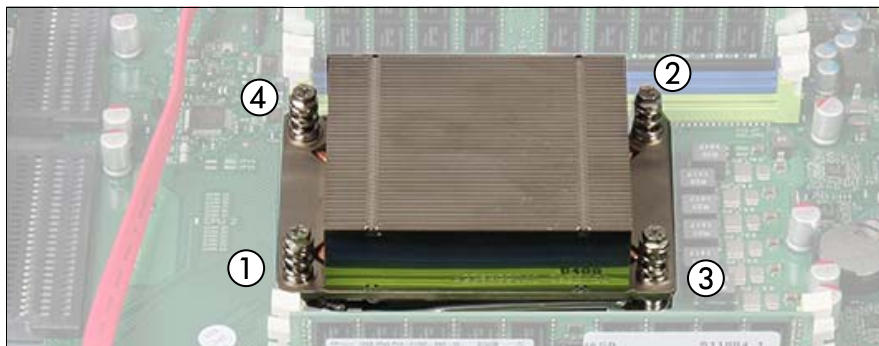
図 170: ヒートシンクの取り付け
