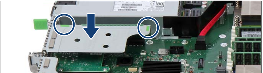
図 16: ライザーモジュールの取り付け（ライザーモジュールの例 3）
