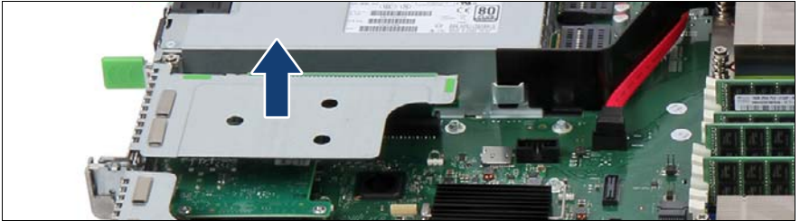
図 15: ライザーモジュールの取り外し（ライザーモジュールの例 3）
