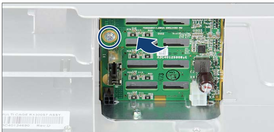
図 49: 4x 2.5 インチ HDD SAS バックプレーンの取り外し
