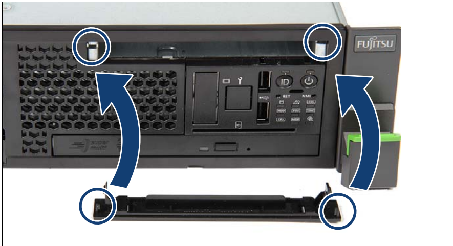
図 151: LSD ダミーカバーの挿入
