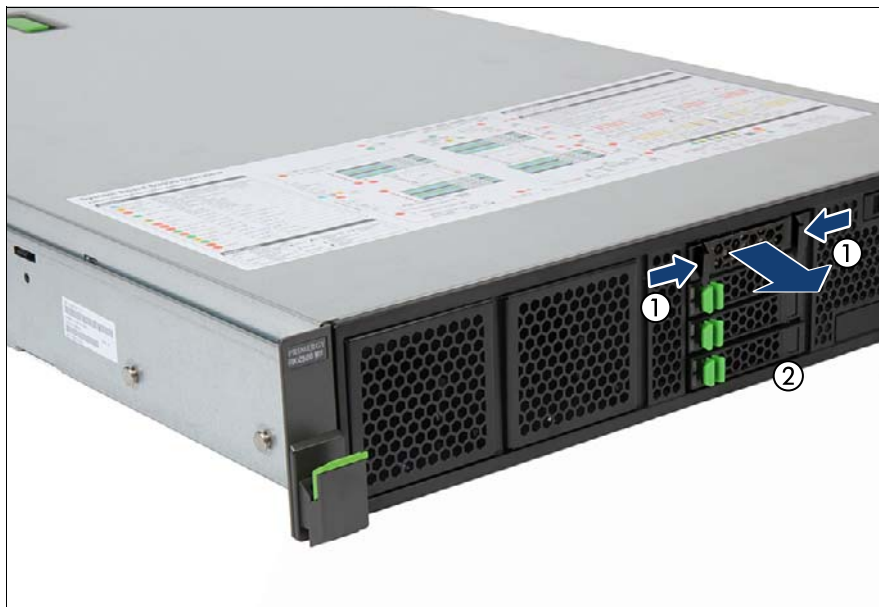
図 35: 2.5 インチダミーモジュールの取り外し
