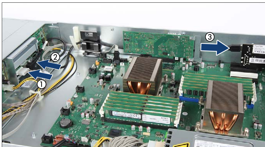
図 181: USB ケーブルの USB 3.0 インタフェースカードへの接続
