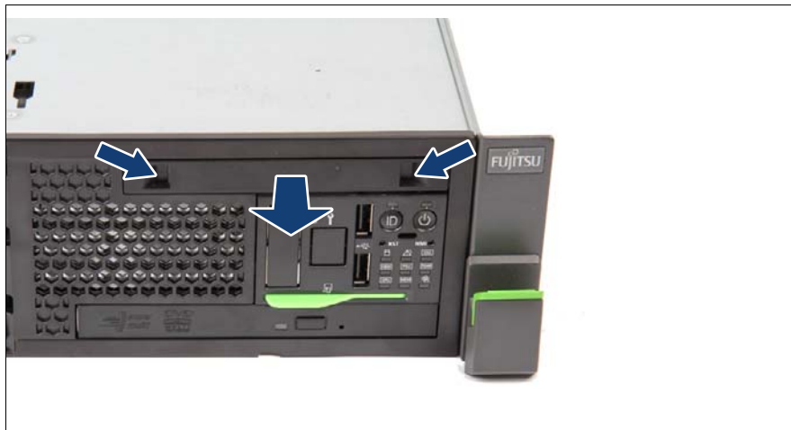
図 145: LSD ダミーカバーの取り外し
