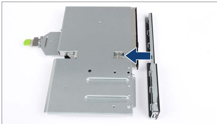
図 174: ODD 取り付けプレートの前面への取り付け
