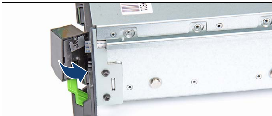
図 223: フロントパネルの耳への取り付け
