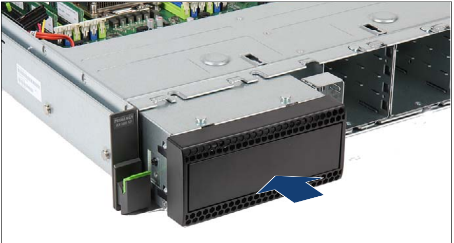
図 204: テープドライブのダミーモジュールが付いたドライブケースの取り付け
