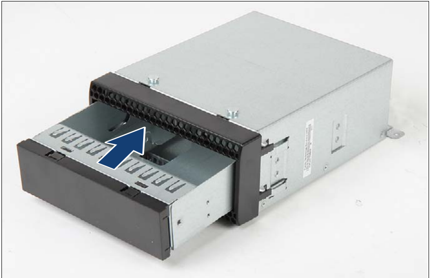
図 201: テープドライブのダミーモジュールの取り付け (A)
