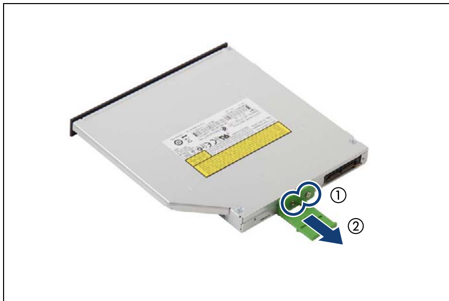
図 159: ODD ラッチの取り外し
