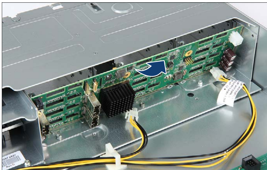
図 54: 2.5 インチ HDD SAS バックプレーンの取り外し (B)
