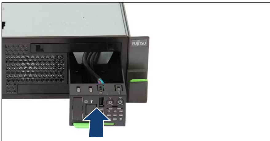
図 207: フロントパネルケーブルの接続
