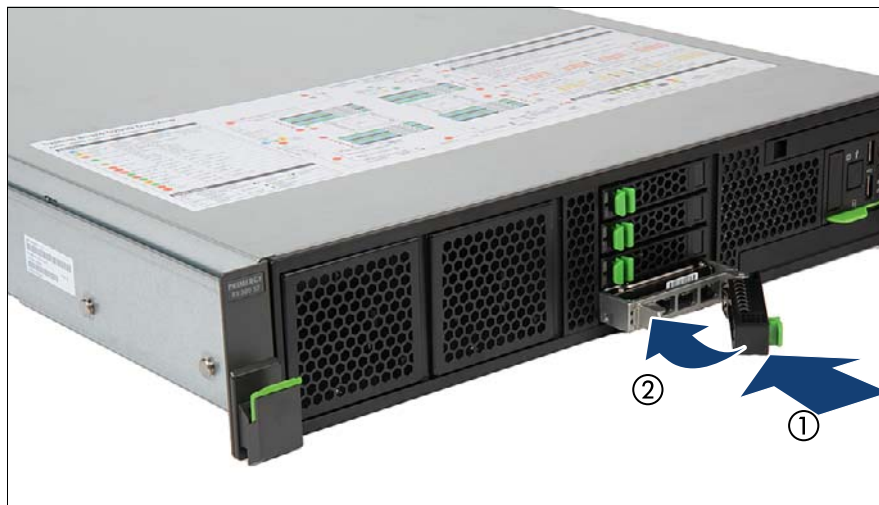
図 37: 2.5 インチ HDD/SSD モジュールの挿入
