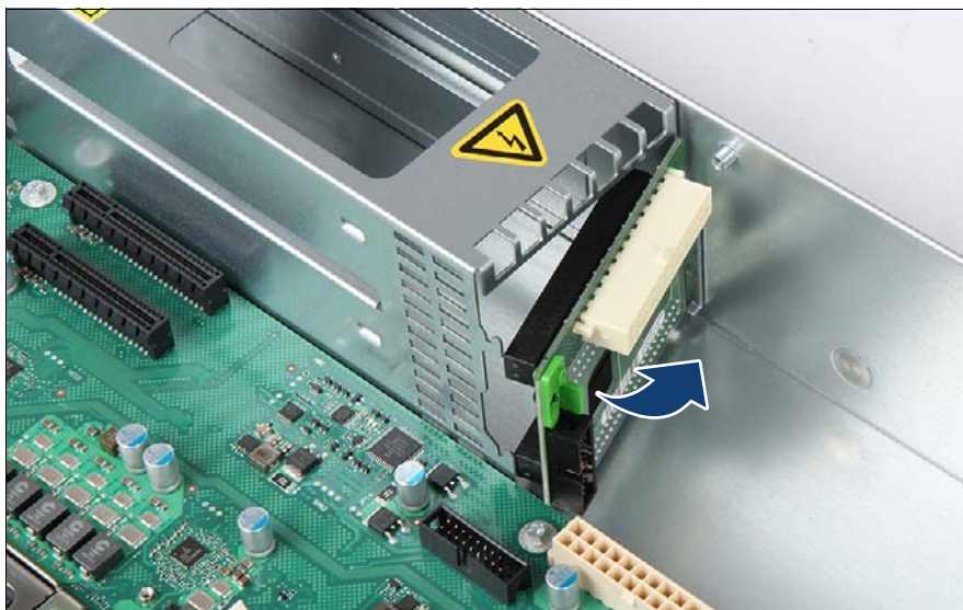
図 24: パワーバックプレーンの取り外し (B)
