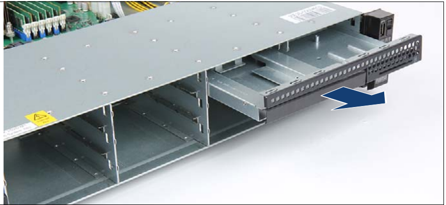
図 162: ODD 取り付けプレートの取り外し
