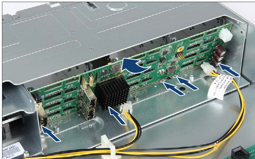
図 55: 12x 2.5 インチ HDD SAS バックプレーンの取り付け (A)
