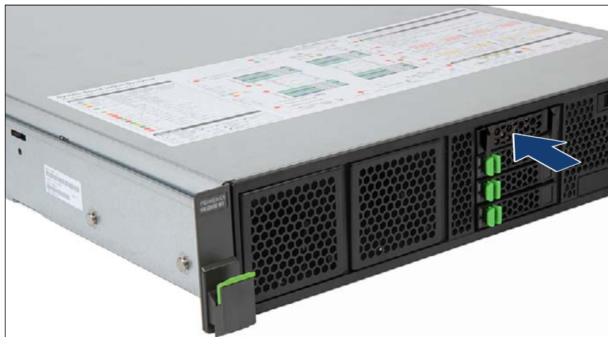
図 40: 2.5 インチ ダミーモジュールの取り付け
