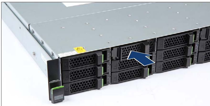
図 47: 3.5 インチ ダミーモジュールの取り付け
