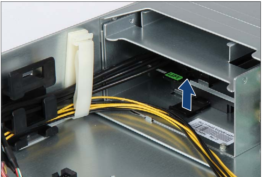
図 152: ODD ダミーモジュールの取り外し
