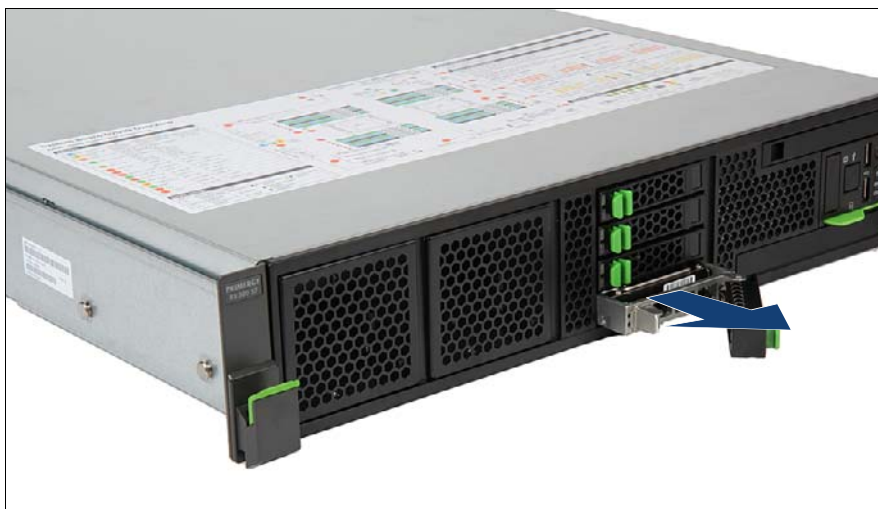
図 39: 2.5 インチ HDD/SSD モジュールの取り外し
