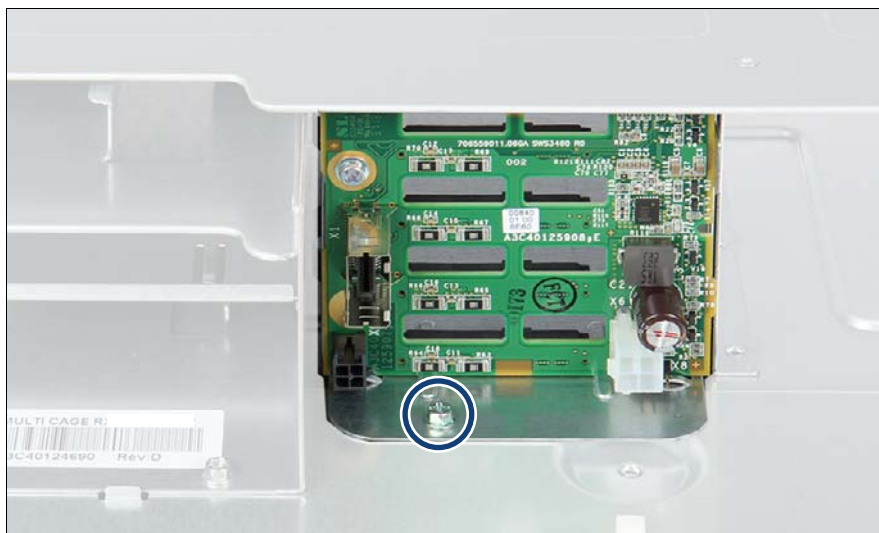
図 68: 4x 2.5 インチ HDD SAS バックプレーンの取り外し
