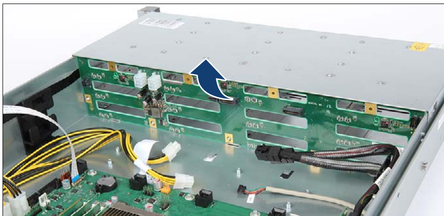
図 61: 3.5 インチ HDD SAS/SATA バックプレーンの取り外し (A)
