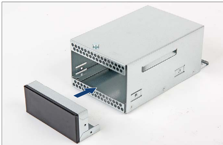
図 185: テープドライブのダミーカバーの取り付け
