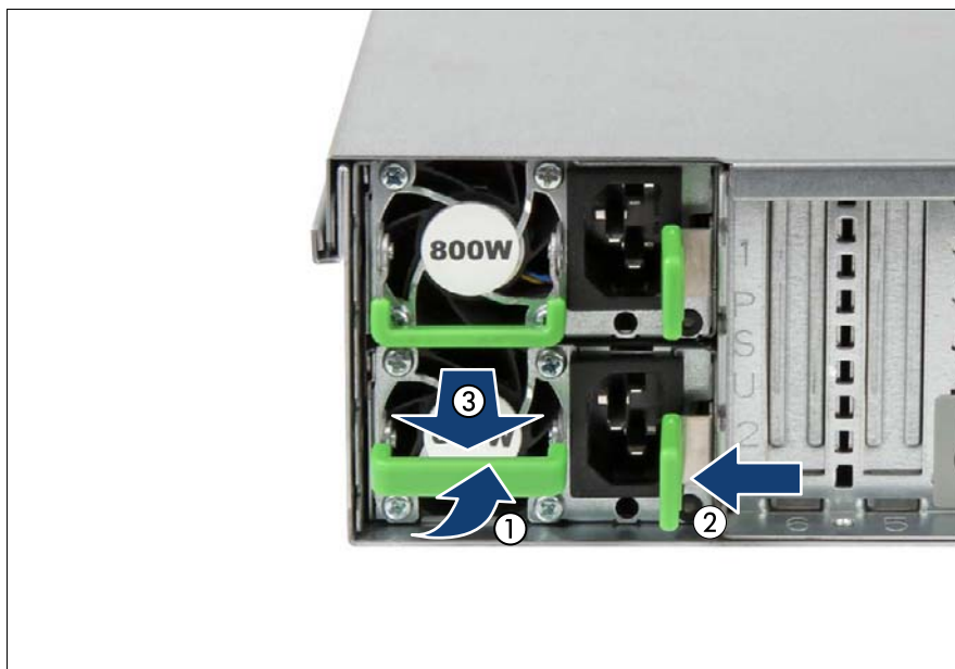
図 18: ホットプラグ電源ユニットの取り外し
