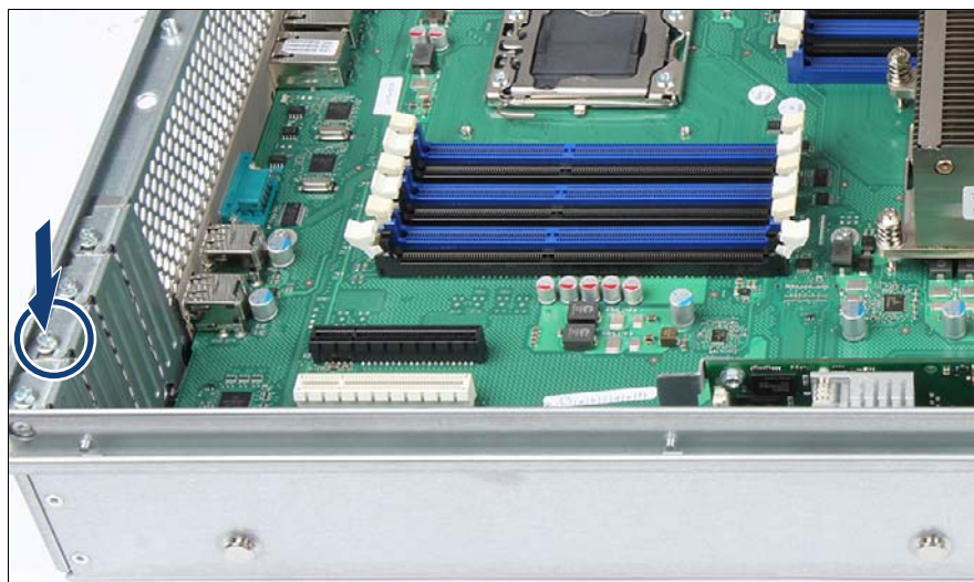
図 88: スロットブラケットの取り付け
