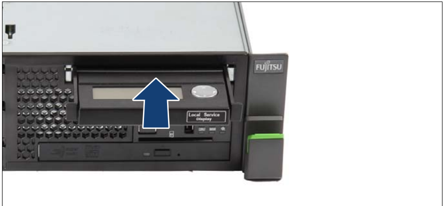
図 146: LSD モジュールの取り付け
