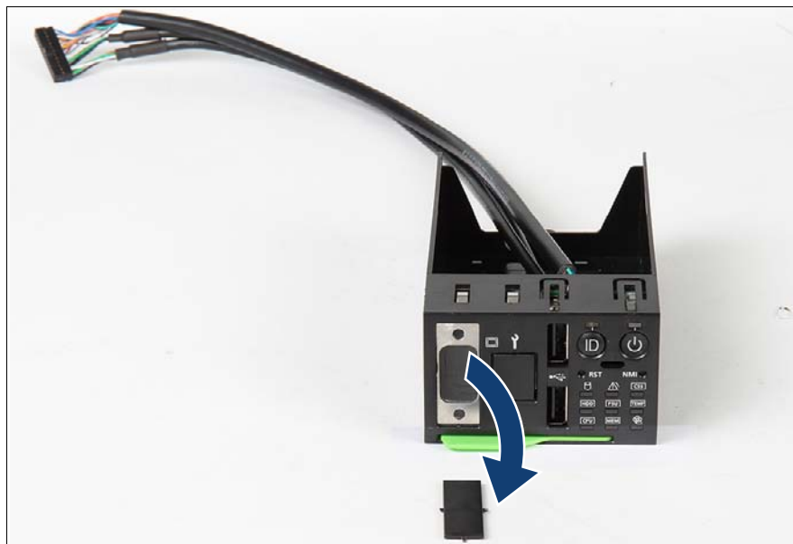
図 209: 前面 VGA カバープレートの取り外し
