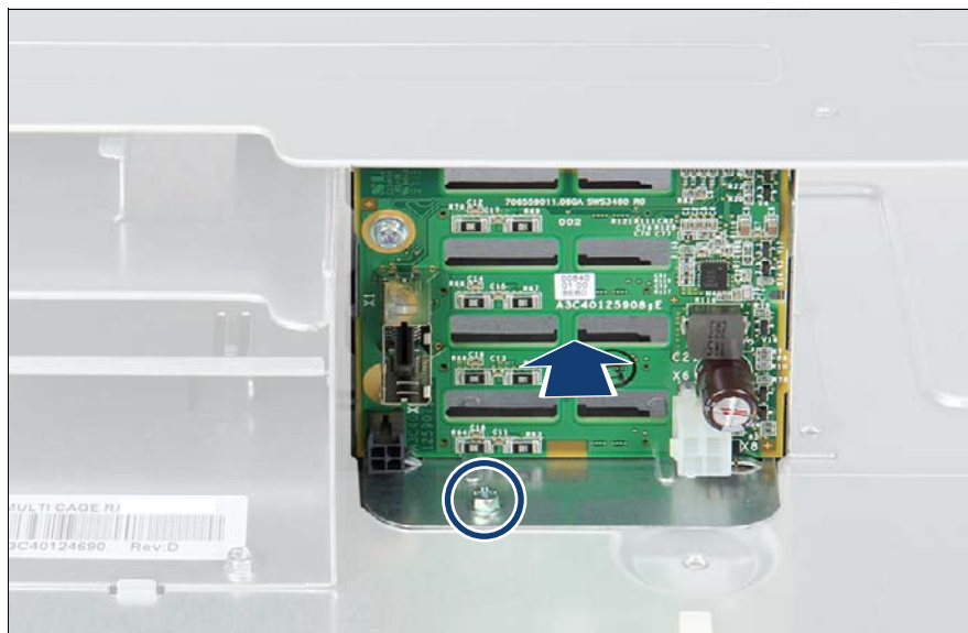
図 67: 4x 2.5 インチ HDD SAS バックプレーンの取り外し
