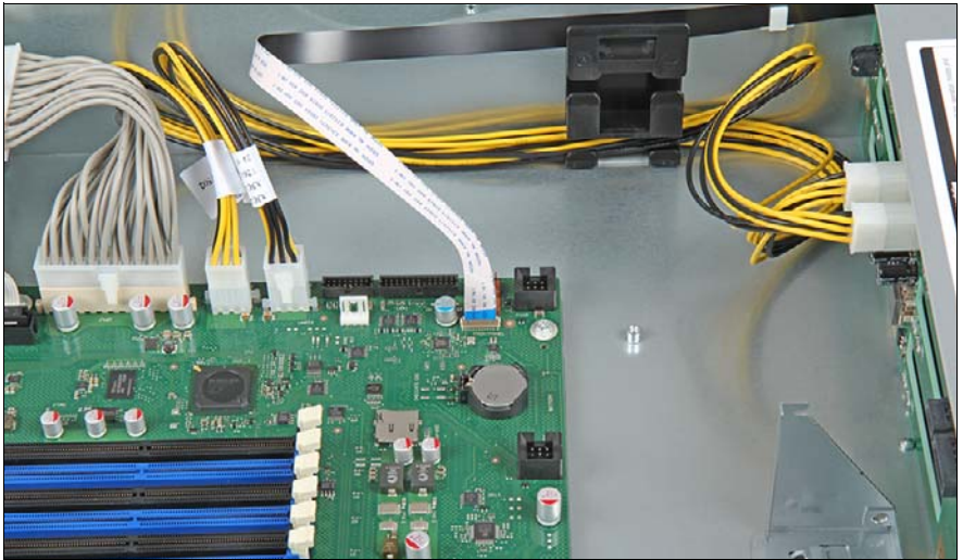
図 226: フロントパネルケーブルの接続
