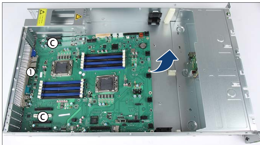
図 251: システムボードの取り外し
