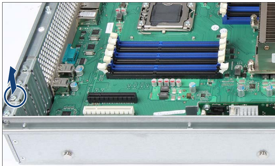
図 85: スロットブラケットの取り外し
