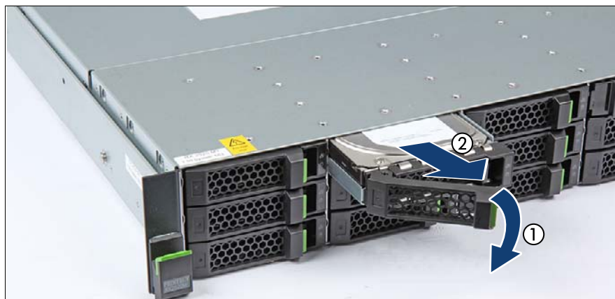
図 46: 3.5 インチ HDD モジュールの取り外し
