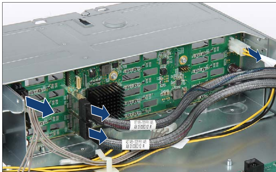
図 52: 12x 2.5 インチ HDD SAS バックプレーンからのケーブルの取り外し
