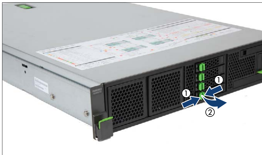
図 38: 2.5 インチ HDD/SSD モジュールの取り外し
