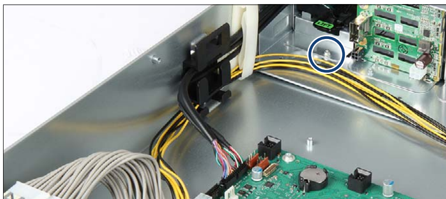
図 218: フロントパネルケージの挿入
