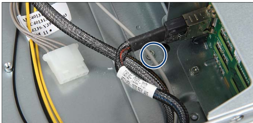
図 180: RDX 内蔵ドライブケースの取り付け
