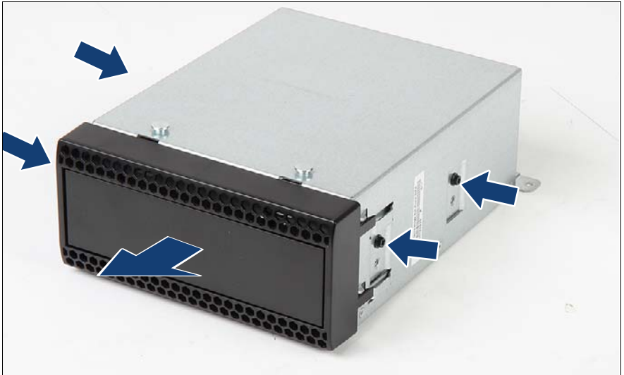
図 189: テープドライブのダミーモジュールの取り外し
