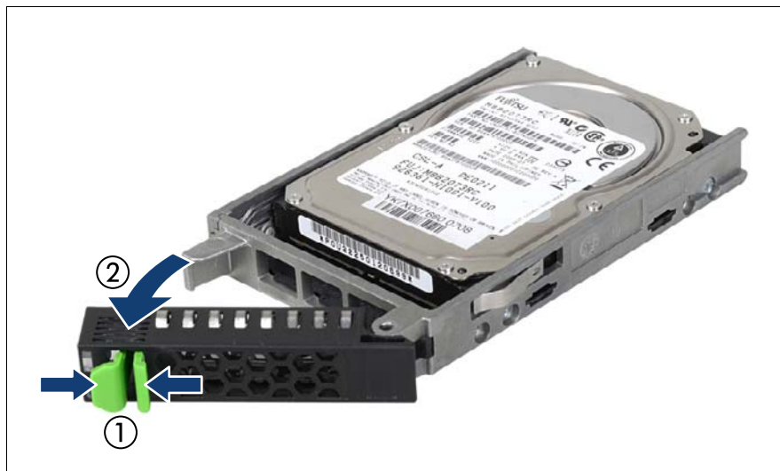
図 36: 2.5 インチ HDD/SSD モジュールのロックレバーを開く
