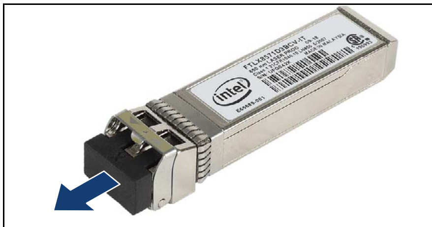
図 107: 光ポート保護プラグの取り外し
