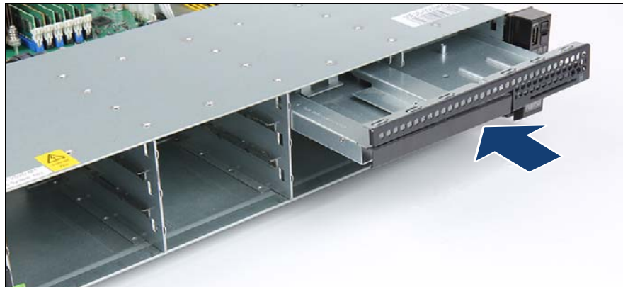
図 175: ODD 取り付けプレートの取り付け
