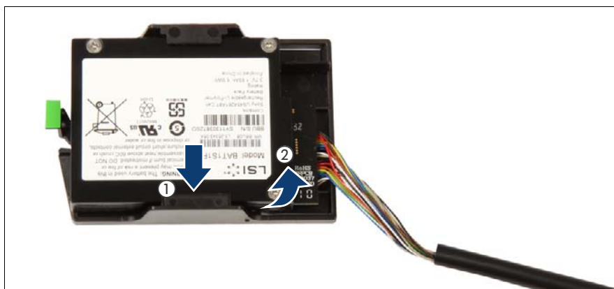
図 126: ホルダーからの BBU の取り外し
