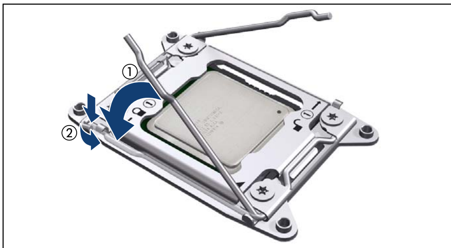
図 158: ソケットリリースレバー 2 を閉じます。
