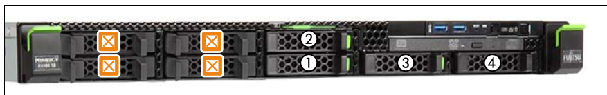
図 48: 最大 4 x 2.5 インチ HDD/SSD の取り付け順序
