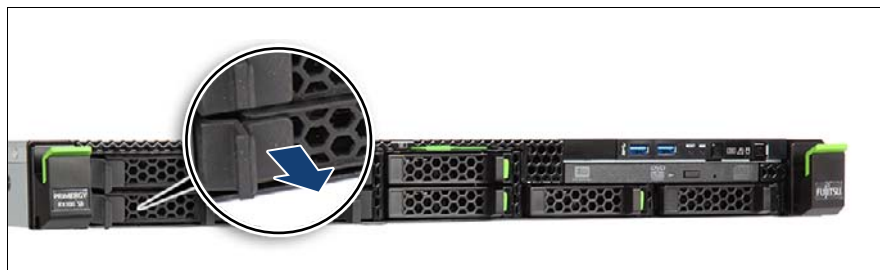
図 54: ダミーロックの取り外し
