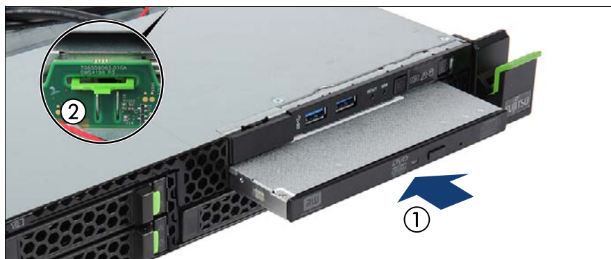
図 164: ODD の取り付け
