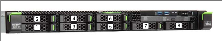
図 51: 最大 8 台の 2.5 インチ HDD/SSD の命名体系
