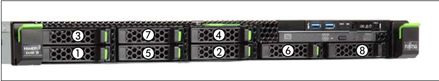
図 50: 最大 8 つの HDD/SSD ベイでの取り付け順序
