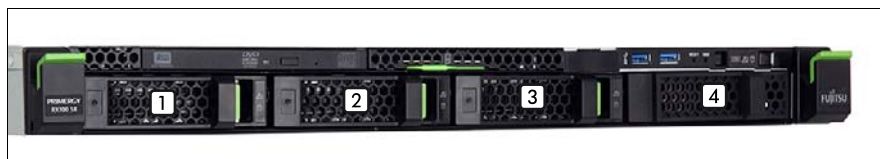
図 77: 最大 4 台の 3.5 インチ HDD の命名体系
