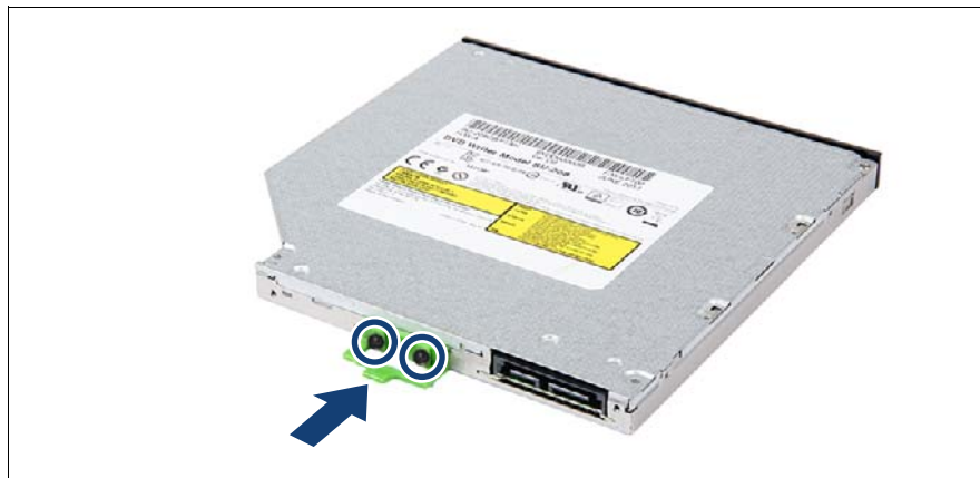
図 163: ODD への ODD ラッチの取り付け
