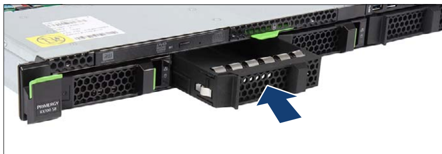
図 81: 3.5 インチダミーモジュールの取り付け
