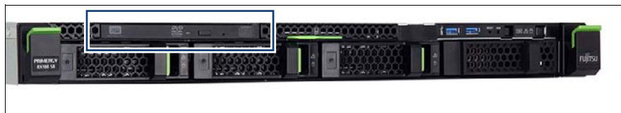
図 156: ODD ベイの位置 - 3.5 インチ HDD 構成の例
