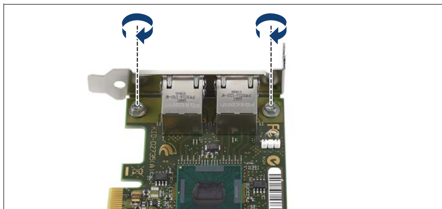
図 93: スロットブラケットの固定 - D2735
