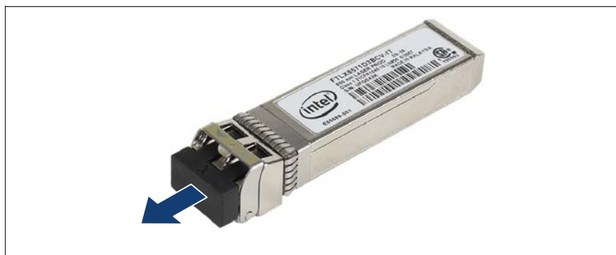
図 101: 光ポート保護プラグの取り外し
