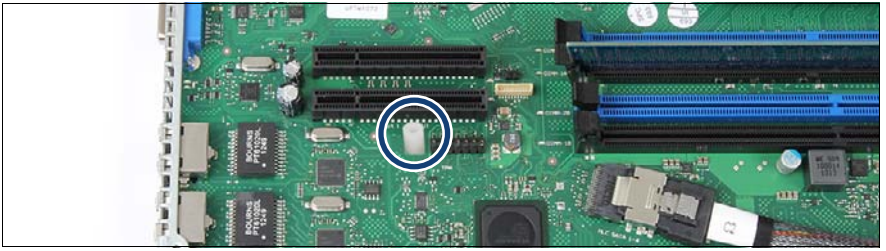
図 198: システムボードへの TPM スペースの挿入
