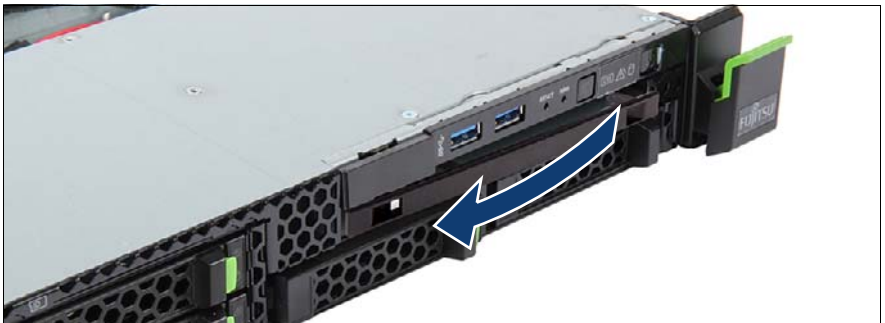
図 162: ダミーカバーの取り外し
