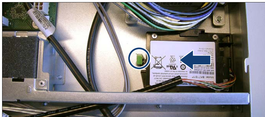
図 137: BBU とホルダーの取り外し
