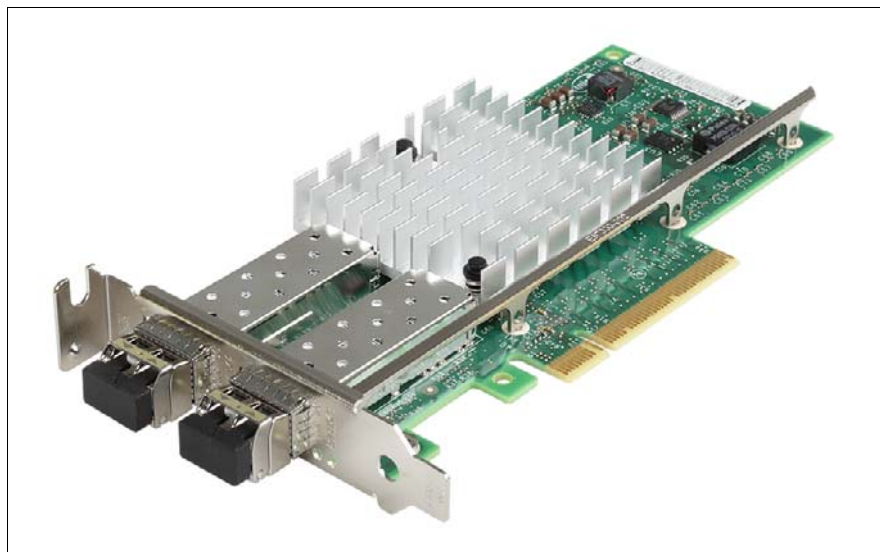
図 106: 2 つ目の SFP+ トランシーバモジュールの取り付け
