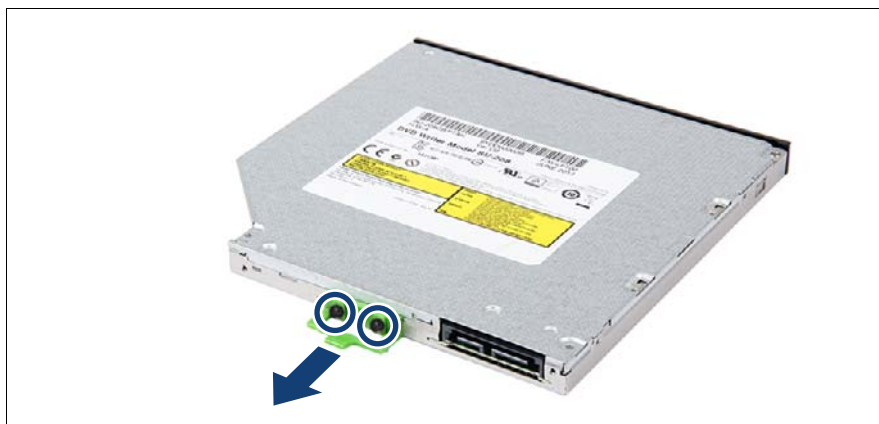
図 168: ODD ラッチの ODD からの取り出し
