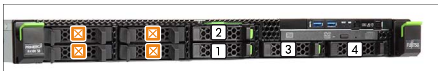
図 49: 最大 4 台の 2.5 インチ HDD/SSD の命名体系
