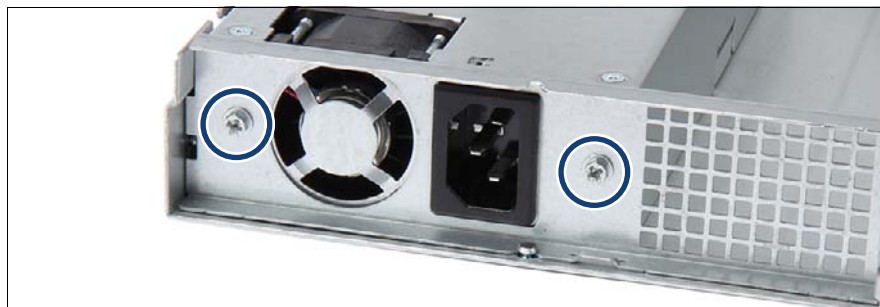
図 22: ネジの取り外し
