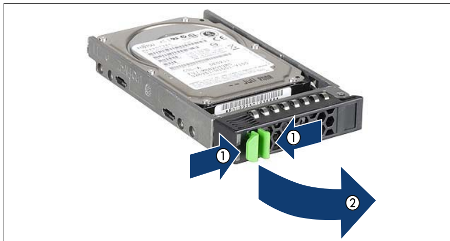
図 17: 2.5 インチ HDD/SSD モジュールのロック解除
