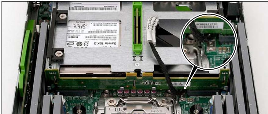
図 54: FBU ケーブルを隙間に通す（分かりやすいようにヒートシンクが取り外されています）
