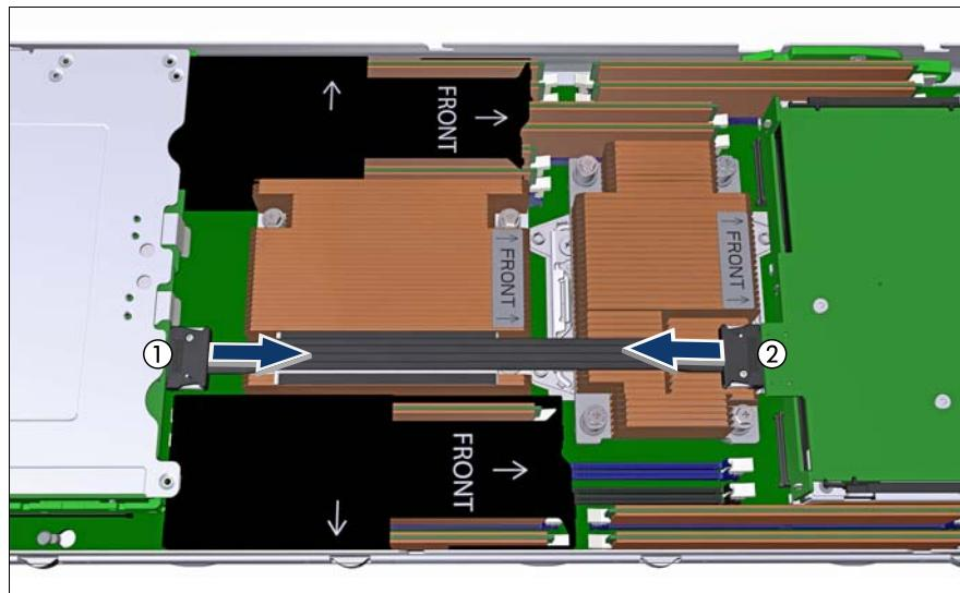
図 49: SAS RAID ミニケーブルの取り外し
