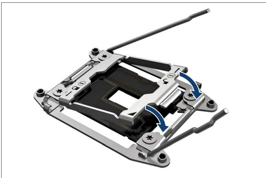
図 90: ロードプレートを閉じる
