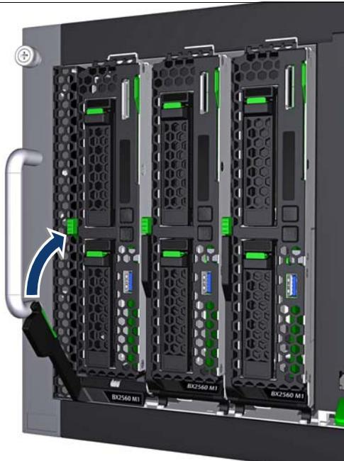
図 13: サーバブレードのロック
