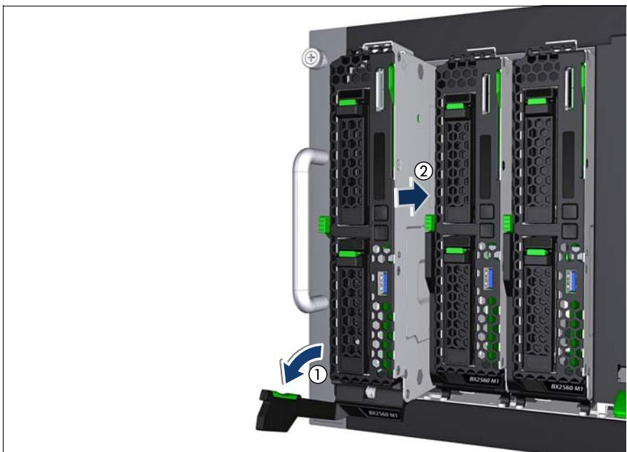
図 12: サーバブレードの取り付け
