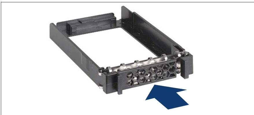
図 22: 2.5 インチダミーモジュールの取り付け
