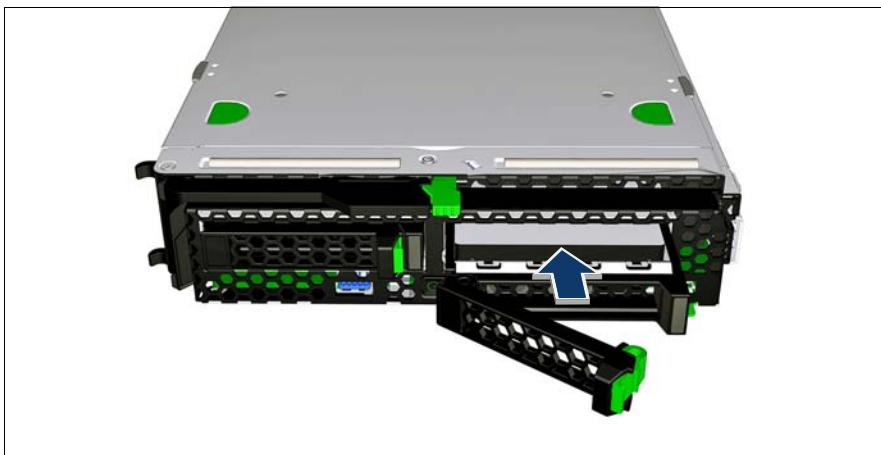
図 19: 2.5 インチ HDD/SSD モジュールの取り付け
