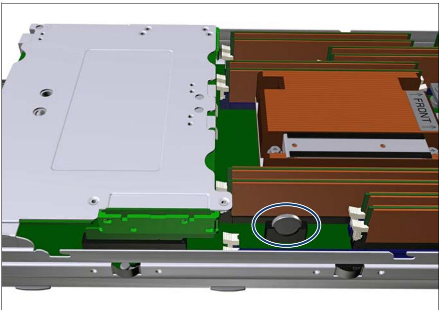
図 104: システムボード D3320 上の CMOS バッテリーの位置（楕円で囲んだ部分）
