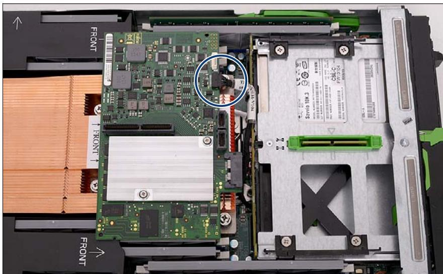
図 56: SAS RAID モジュールへの FBU ケーブルの接続
