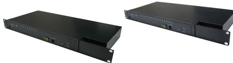
図1 アナログKVMスイッチ(8ポート/16ポート) 外観
