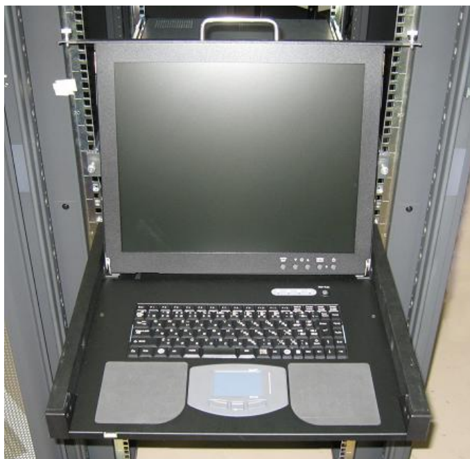
図 5. 液晶ディスプレイ引き起こし時
