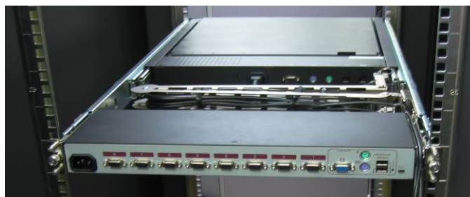
図 6 .KVM スイッチ(PY-KVFA08)を搭載した時
