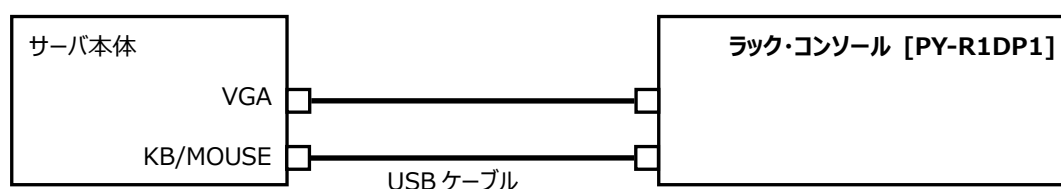
図 7-1. 接続図(RC25 とサーバの直接接続)
