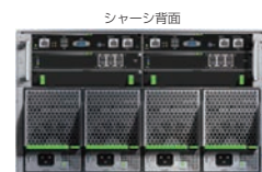
電源ユニット×4スロット コネクションブレード×4スロット マネジメントブレード×2スロット
