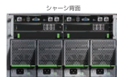
シャーシ背面 電源ユニット×4スロット コネクションブレード×4スロット マネジメントブレード×2スロット
