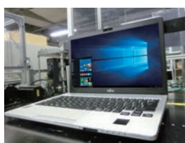
液晶ディスプレイの開閉動作を繰り返し、破損などがないか、耐久性のチェックを行います。
