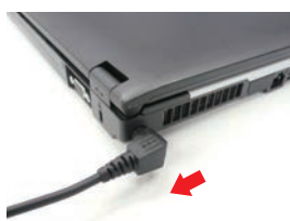
コネクタ部の耐久性を確認するため、ACアダプター、USB、PCカードなどの各種インターフェースに対し、コネクタ挿抜の繰り返しや、大きな力で引っ張るといった試験を行い、強度のチェックを行います。
