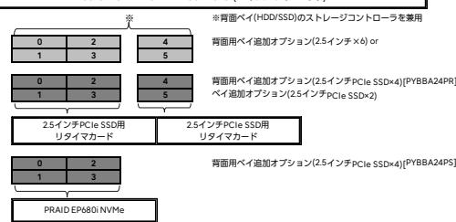
背面(Pcie SSD×4、x2)：2.5インチPCIe SSD用リタイマカード
