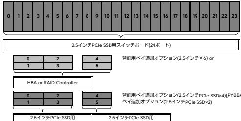
前面(PCIe SSD×24) : 2.5インチPCIe SSD用スイッチボード
