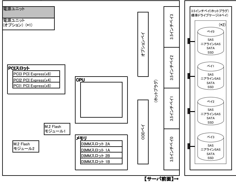
(\*)1 450W電源が標準搭載のタイプのみ冗長電源ユニットを手配可能です。
