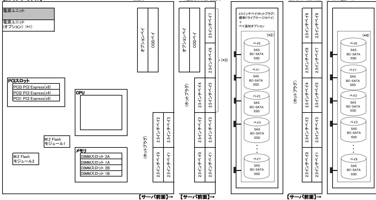
(\*)1 450W電源が標準搭載のタイプのみ冗長電源ユニットを手配可能です。
