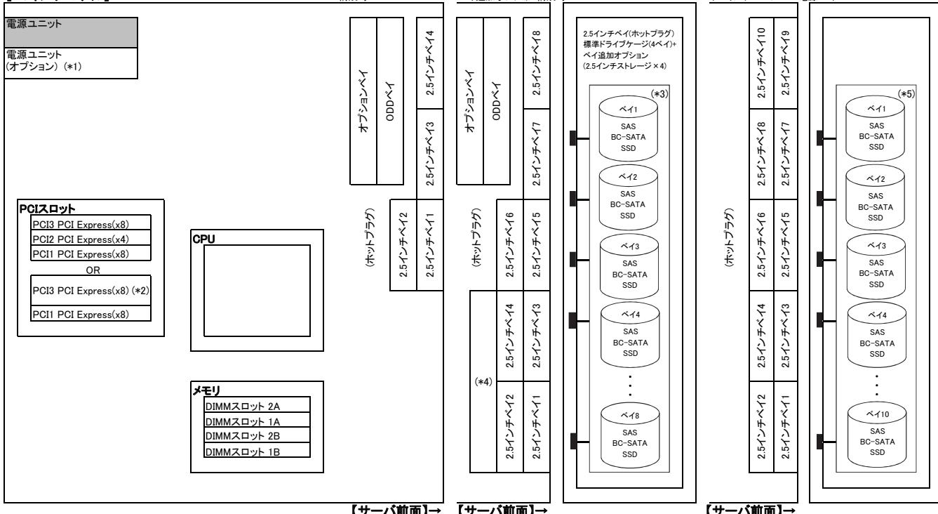
(\*1) 450W電源が標準搭載のタイプのみ冗長電源ユニット/内蔵型バッテリーユニットを手配可能です。
