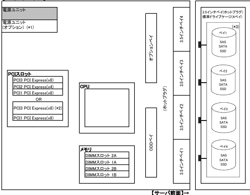
(\*1) 450W電源が標準搭載のタイプのみ冗長電源ユニット/内蔵型バッテリーユニットを手配可能です。
