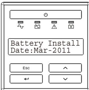
10. YES を選択すると、図のようなバッテリーインストールの日付の画面が現れますので、バッテリーを交換した月と西暦を UP/DOWN ボタンで選択して ENTER ボタンを押してください。
