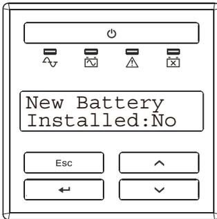
9. UPS には図のように新しいバッテリーを取り付けたかどうかの確認が表示されますので (New Battery Installed:No)、UP/DOWN ボタンで YES を選択して、ENTER ボタンを押してください。
