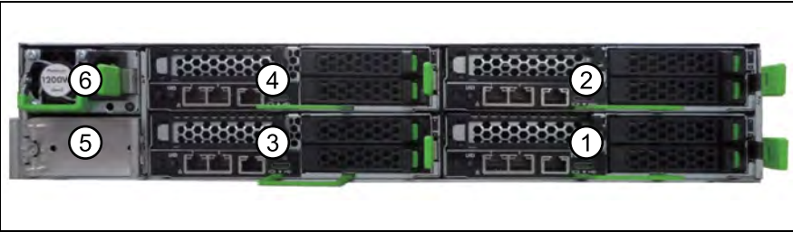
図 24: サーバノードを搭載した シャーシの背面
