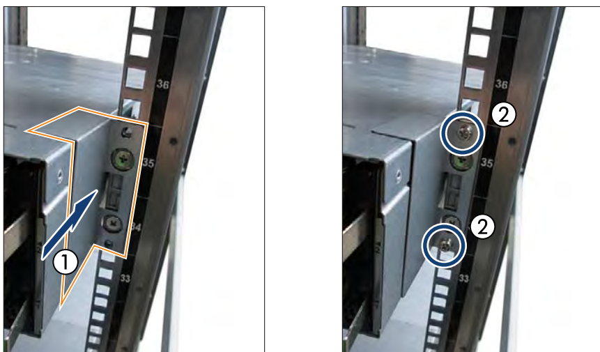
図 20: 背面右側ラック支柱への背面固定ブラケットの取り付け
