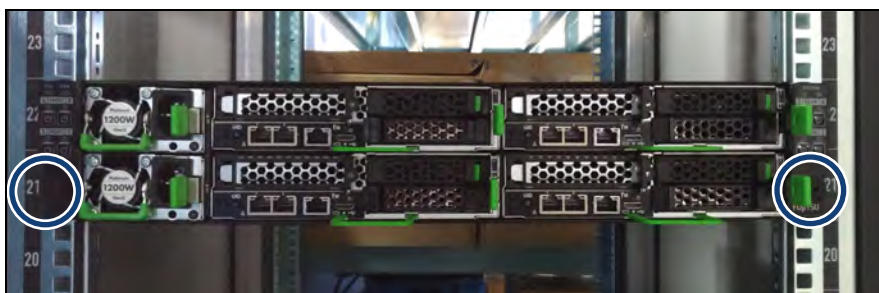
図 18: ラックへのシャーシの固定
