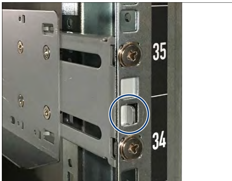
図 15: 背面右側ラック支柱への右側のレールノーズの取り付け
