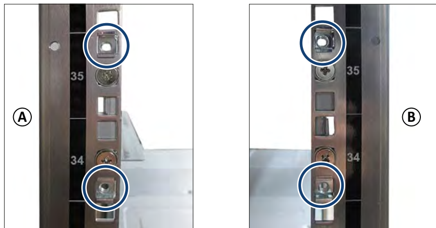
図 16: 背面ラック支柱のケージナットの取り付け
