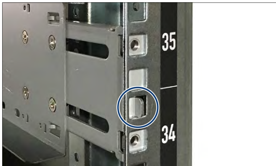
図 12: 背面左側ラック支柱への左側のレールノーズの取り付け
