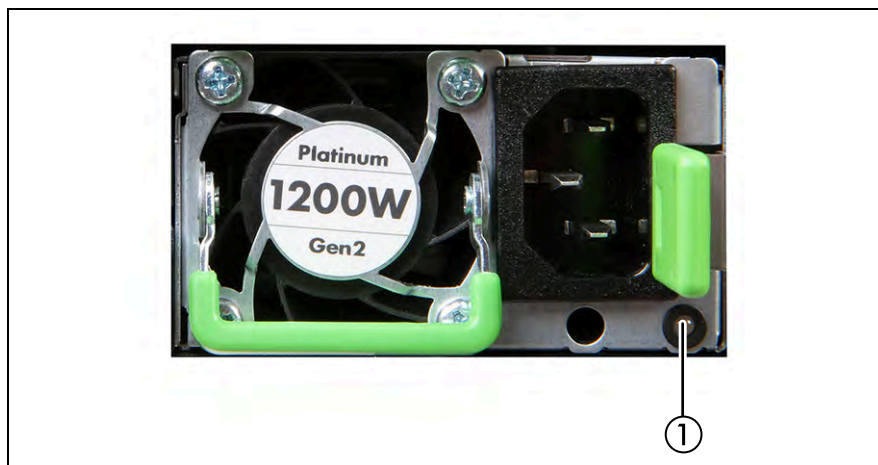
図 26: ホットプラグ PSU の表示ランプ
