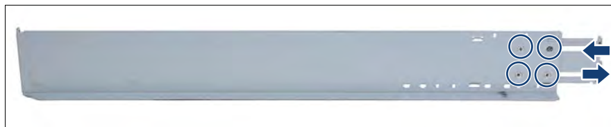
図 11: 左側のレールの長さを調整します。
