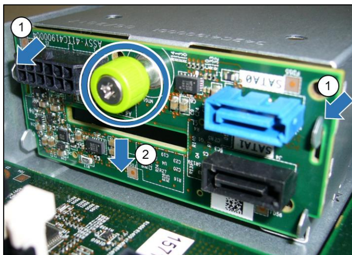
図 21: HDD バックプレーンの取り付け
