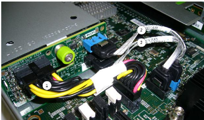
図 19: ケーブル類の取り外し
