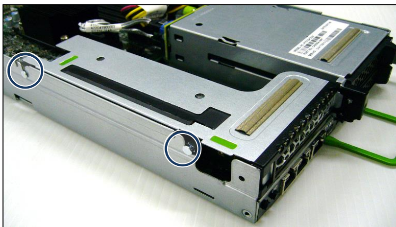
図 6: ライザーモジュールの取り付け (B)
