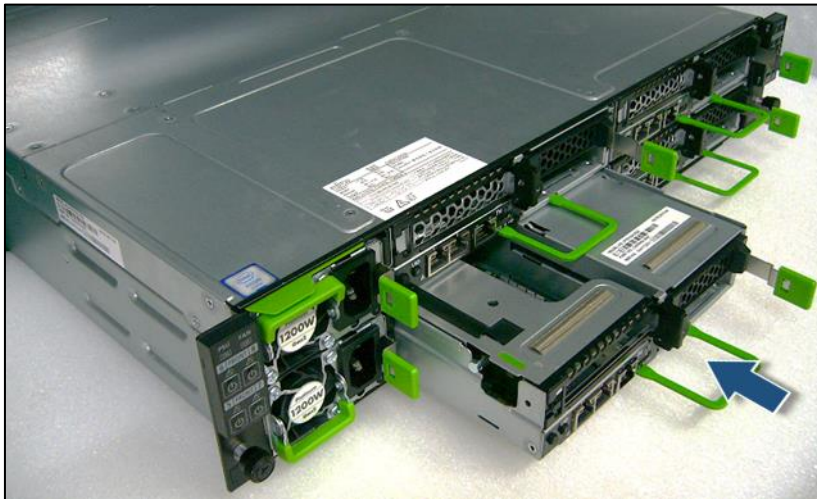
図 7: サーバノードの取り付け
