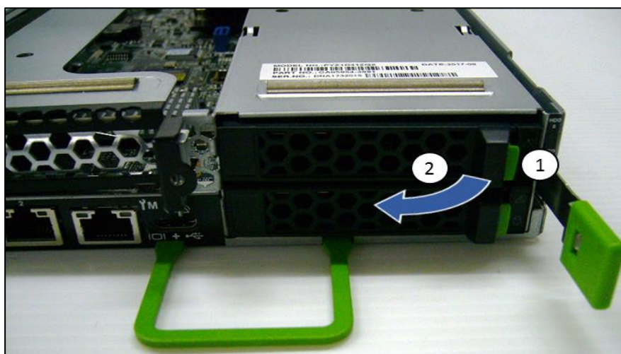
図 16: 2.5 インチ HDD/SSD モジュールの取り外し（A）
