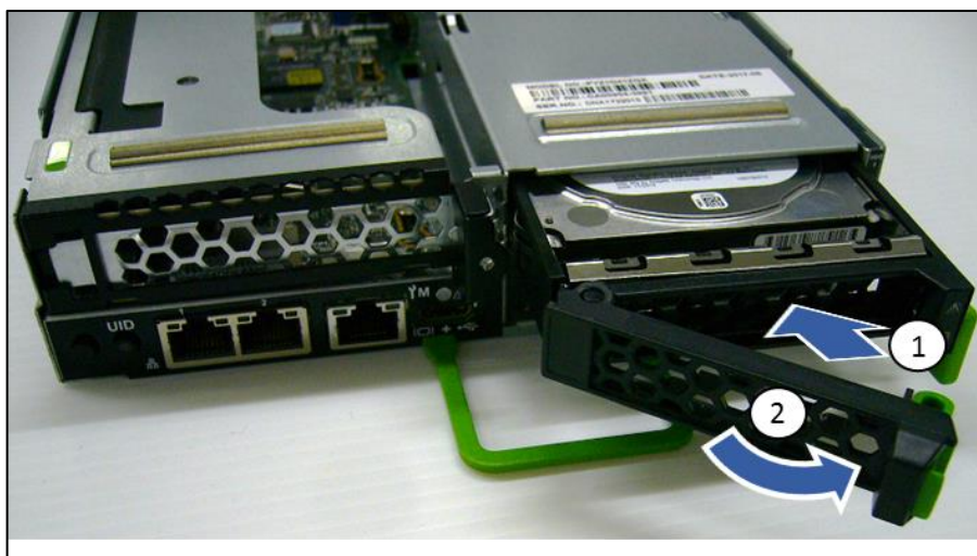
図 15: 2.5 インチ HDD/SSD トレイへの 2.5 インチ HDD/SSD の取り付け
