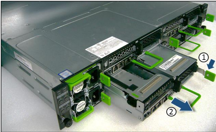
図 3: サーバノードの取り外し
