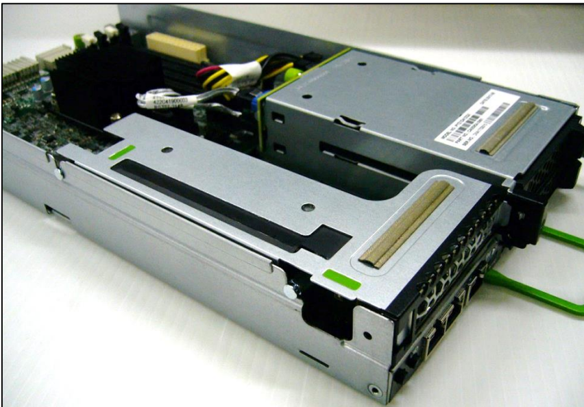
図 4: ライザーモジュールの取り外し
