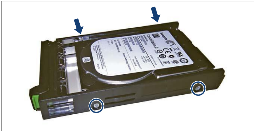
図 13: 2.5 インチ HDD/SSD トレイへの 2.5 インチ HDD/SSD の取り付け (B)
