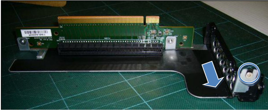
図 24: ライザーモジュールへのコントローラの取り付け
