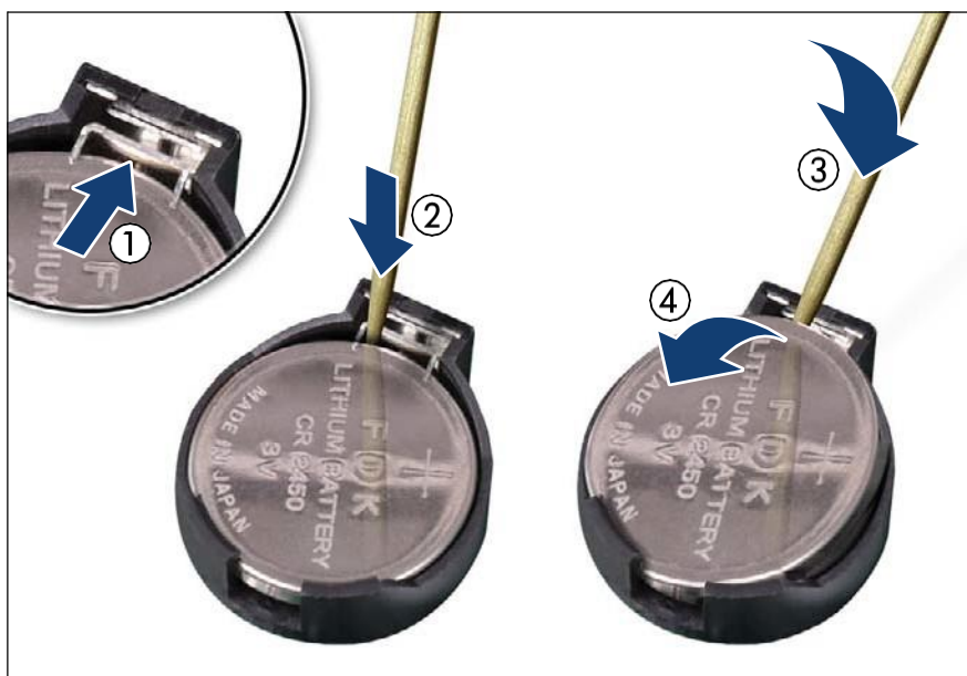
図 41: CMOS バッテリーの取り外し
