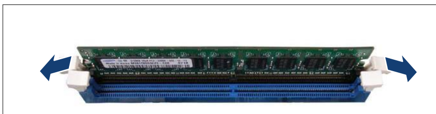
図 32: メモリモジュールの取り外し (A)
