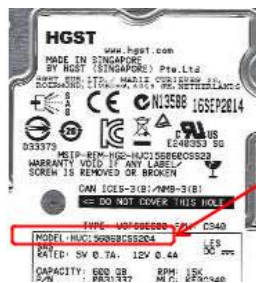
図 18: HDD / SSD のベンダモデル名の確認
