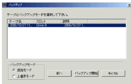
**8** テープのスロットを選択し、バックアップモード（追加モードまたは上書きモード）を選択して [バックアップ開始] をクリックします。
