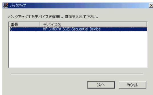
**7** バックアップするデバイスを選択し、媒体をセット後 [次へ] をクリックします。
