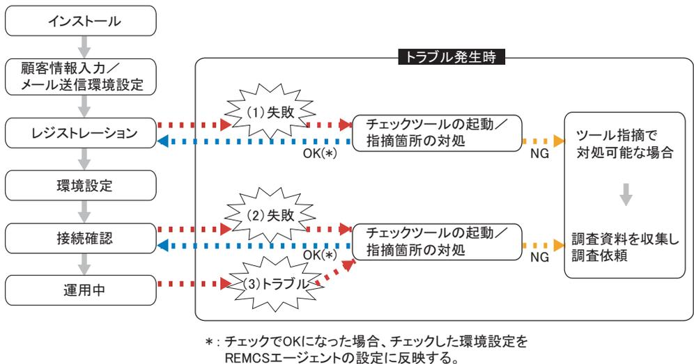
チェックツールは動作に必要な環境定義（装置 ID、接続先 REMCS センタの HTTP サーバ名など）を、REMCS エージェントの環境設定ファイルから読み込みます。V3.0L43 以前の REMCS エージェントがインストールされた環境、または REMCS エージェントをインストールしていない環境での動作については機能が制限されます。詳細については、「5.5.3 注意事項」（→ P.132）を参照してください。
