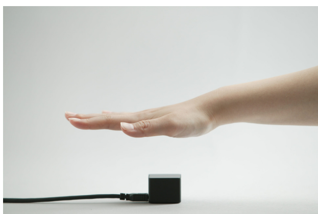
非接触型手のひら静脈センサ装置 (35mm × 35mm × 27mm)
