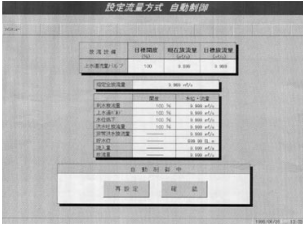
図5 自動制御操作画面例
