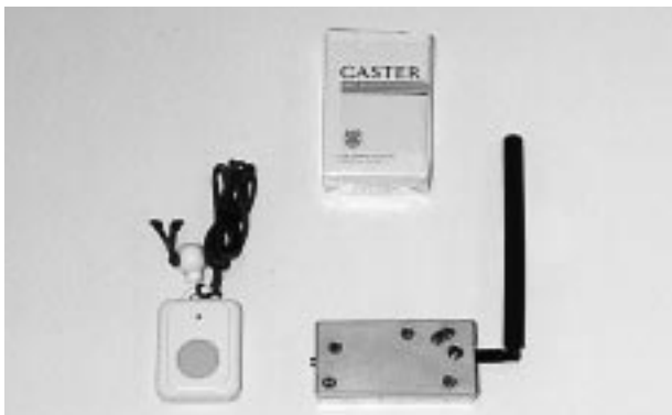
図4 無線ペンダント（左）と内蔵無線受信ユニット（右）
