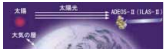
ILAS-IIの観測原理 大気を通過する太陽光を観測
