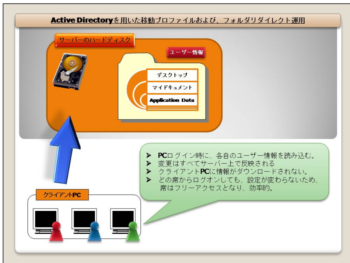
図 1 7. 移動プロファイルによるフォルダリダイレクト
